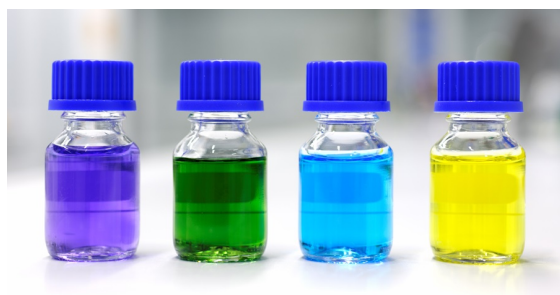
Figura 1.2 – Differenti stati di ossidazione del vanadio: da sinistra a destra V^{2+} , V^{3+} , V^{4+} , V^{5+} . [4]
