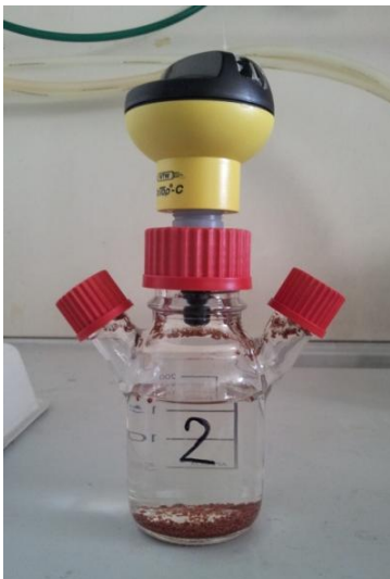
Figura 3.2 Una delle bottiglie usate durante le prove manometriche
