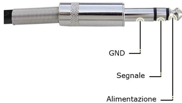
Figura 3.8: Connettore jack tripolare da 6.5 mm con indicazione della mappatura utilizzata.
