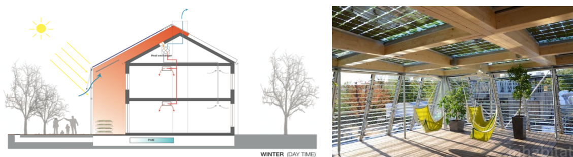
Fig. 41 – A sinistra: principio di funzionamento della serra solare di Prêt à Loger, Delft University of Technology. 10 A destra: vista dall'interno del piano superiore del progetto Canopea, Team Rhone-Alpes. 13
