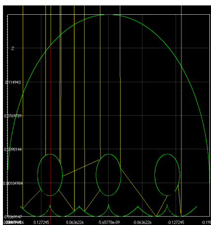
Figura 4.51. Ray-tracing di un pannello con 3 tubi nelle condizioni descritte per la zona 3
