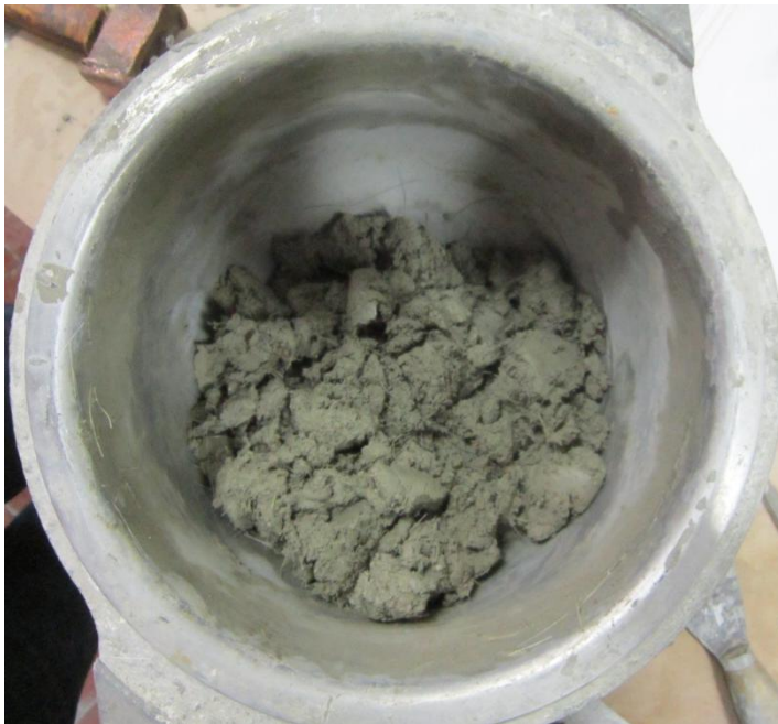
Figura 4. 26 - Risultato dopo una miscelazione senza raffreddamento indiretto
