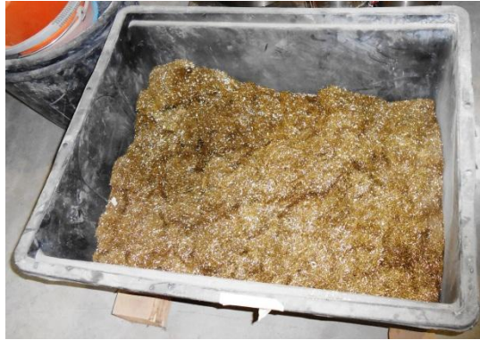
Figura 4. 6 - Microfibre d'acciaio rivestite in ottone
