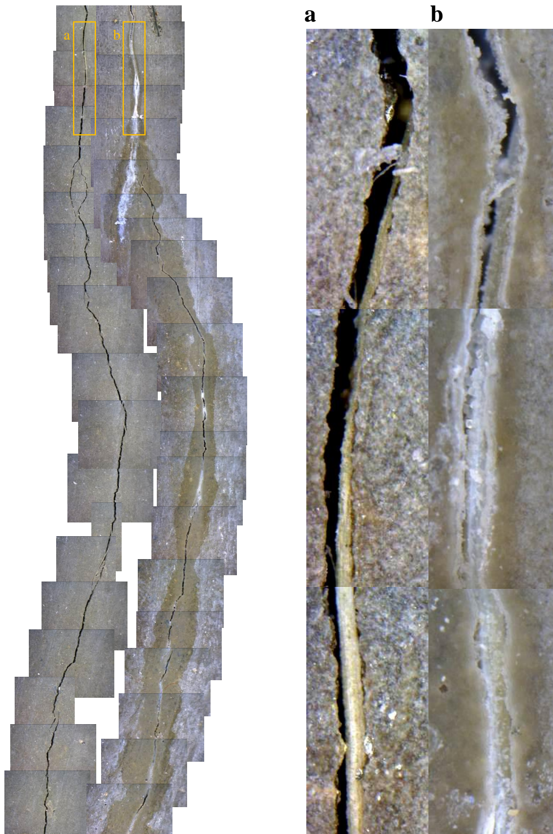
Figura 4. 69 - A sinistra è il precrack, a destra è il risultato dopo 1 mese d'esposizione in acqua. A SX) ingrandimento 50x. A DX) ingrandimento 200x
