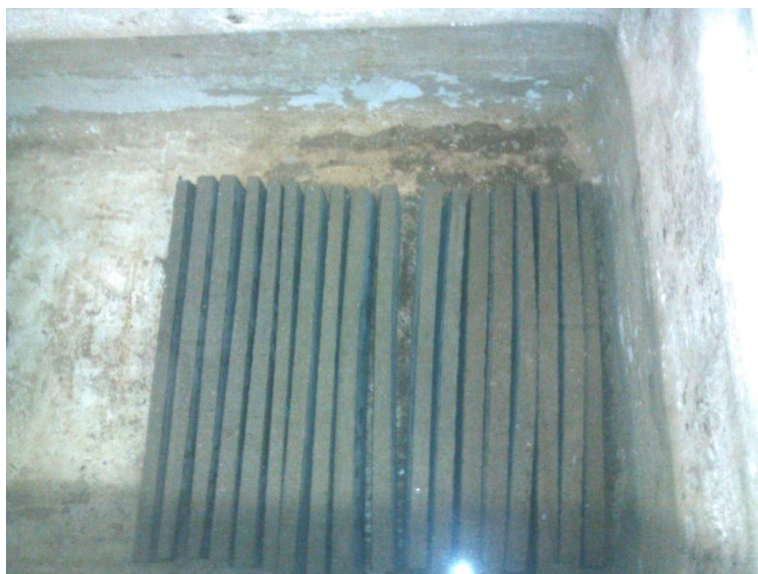
Figura 4. 49 - Provini con condizione d'esposizione immersione in acqua
