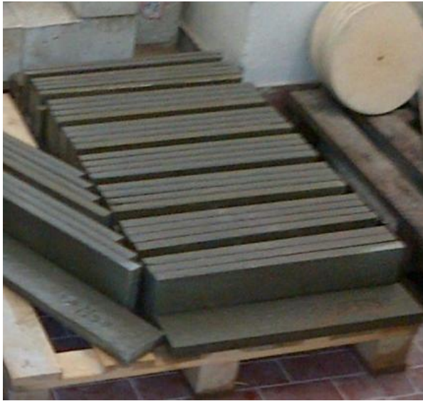
Figura 4. 50 - Provini in esposizione in CAMERA UMIDA 20°-90% U.R
