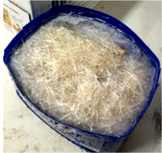
Figura 4. 11 - Fibre di Sisal sature d'acqua
