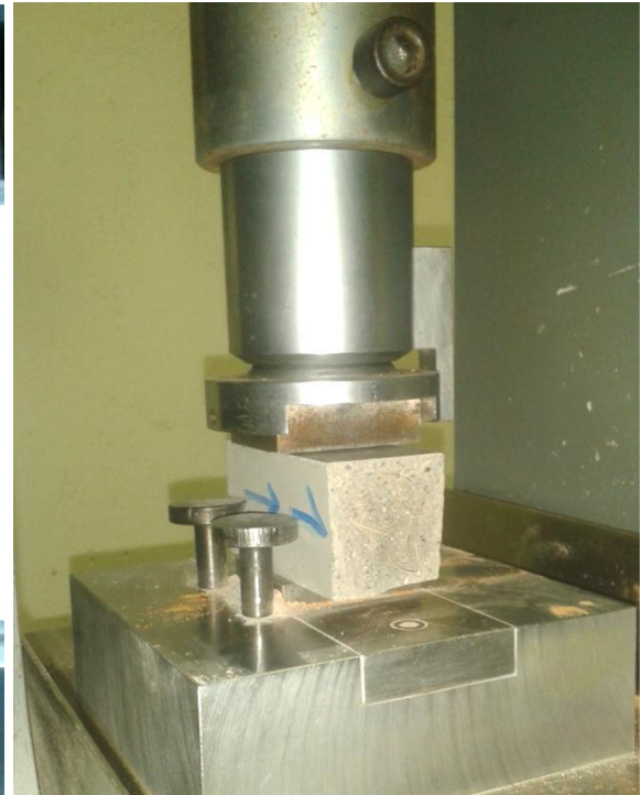
Figura 4. 39 - Prova a compressione semplice
