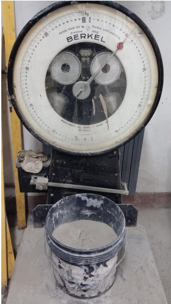
Figura 4. 2 - Cemento durante la fase di pesatura
