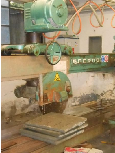
Figura 4. 41 - Taglio delle lastre con lama circolare (SX) e provini tagliati (DX)
