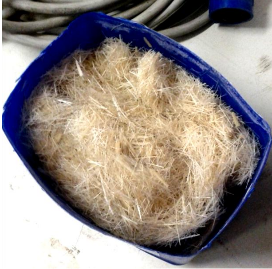
Figura 4. 10 - Fibre di Sisal asciutte
