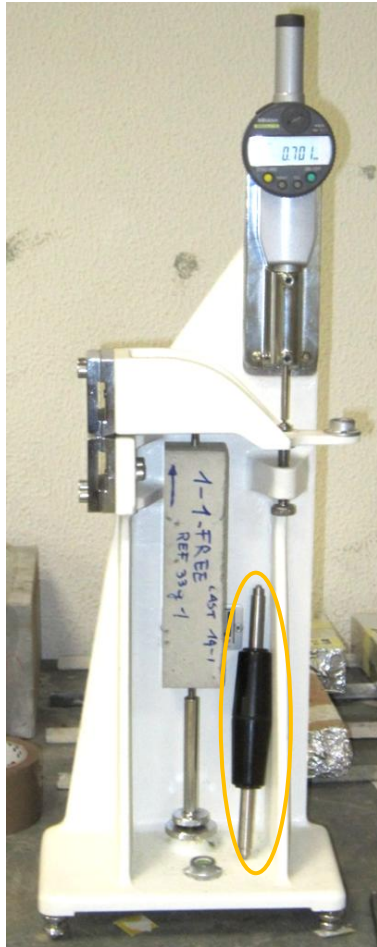
Figura 4.30 - Estensimetro lineare per la misurazione del ritiro assiale
