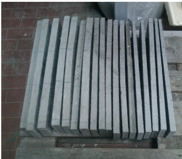
Figura 4. 51 - Provini in esposizione in LABORATORIO Prove Tecnologiche 20° 50%
