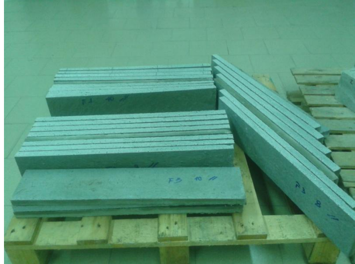
Figura 4. 41 - Taglio delle lastre con lama circolare (SX) e provini tagliati (DX)
