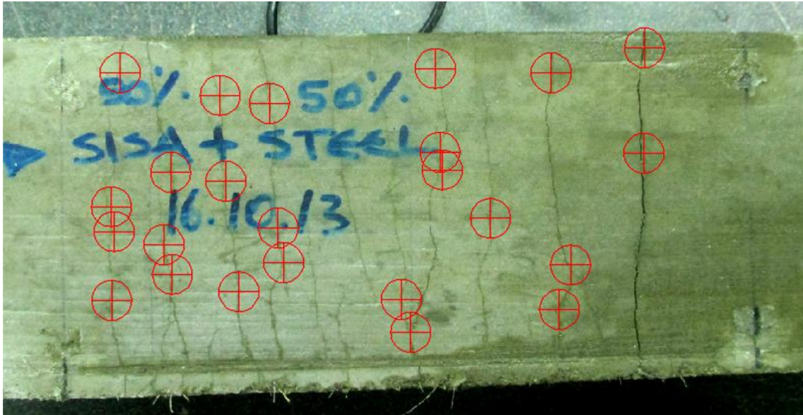
Figura 4. 71 - Mappatura delle fessure tramite CAD
