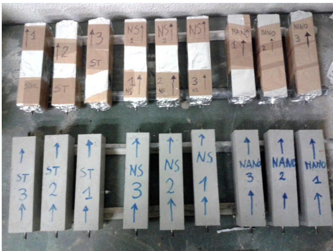
Figura 4. 29 - Provini prismatici 40x40x160 per le misurazioni a ritiro autogeno (sopra) e totale (sotto)
