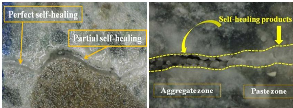
Figura 3.8: formazione e crescita differente dei prodotti di self-healing tra pasta cementizia e aggregati [62]
