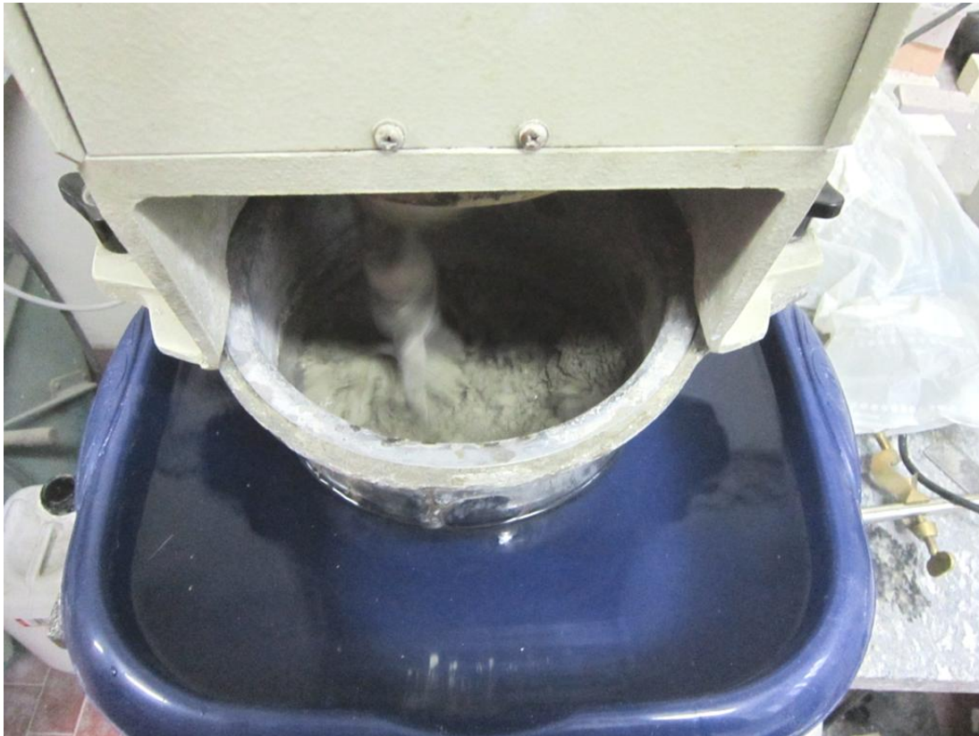
Figura 4.25 - Miscelazione del composto HPFRCC
