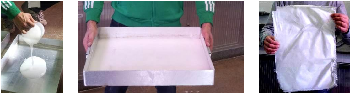
Figura 4. 20 - Realizzazione di un foglio di Nanopulp
