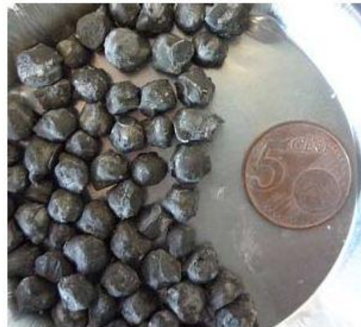
(D) Sealed by epoxy-cement paste
