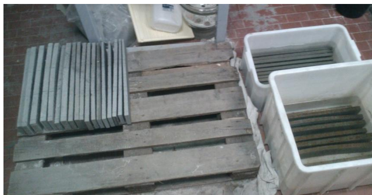
Figura 4. 52 - Provini in esposizione per cicli Wet/Dry
