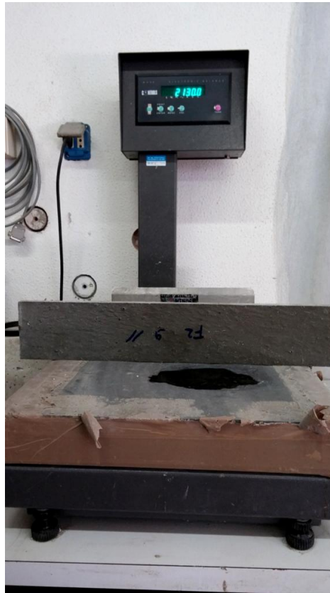
Figura 4. 74 - Controllo del peso per i provini della campagna Sisal Hybrid
