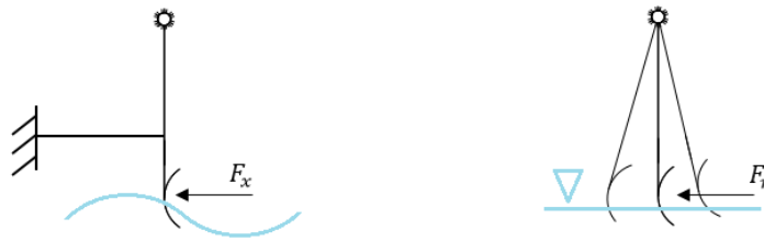
Figura 3.27: I due contributi del forzamento d'onda agente sulla pala
