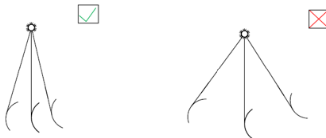
Figura 3.29: Sistema sottoposto a piccole e grandi oscillazioni
