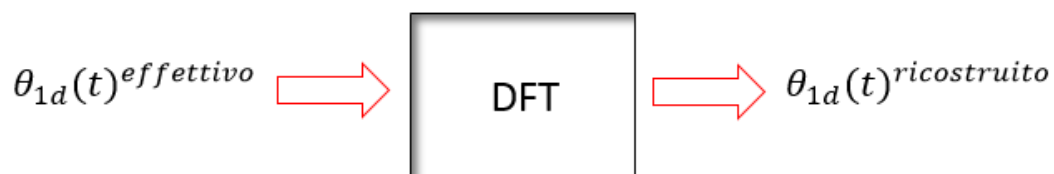
Figura 4.31: Schema del processo di ricostruzione del segnale \theta_{1d}(t) tramite DFT
