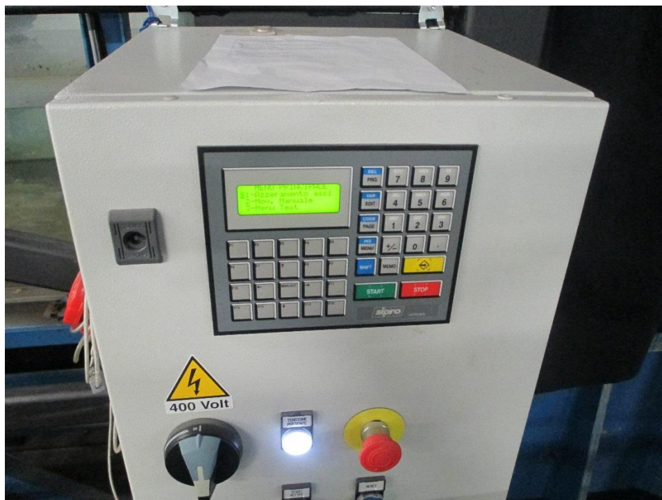
Figura 4.5: Centralina che comanda in anello aperto il moto sincrono del battitore
