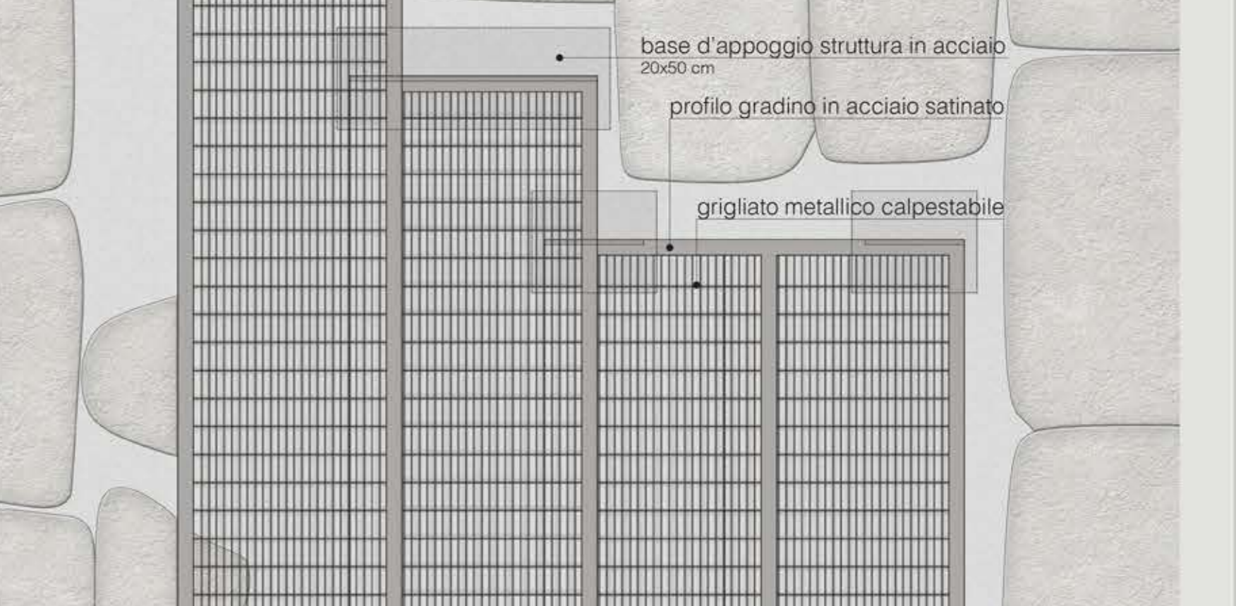
Sezione dd' . Lungo il prospetto ovest una scalinata permette di superare il dislivello morfologico. I gradini sono realizzati tramite il contenimento del terreno attraverso lame di acciaio.
