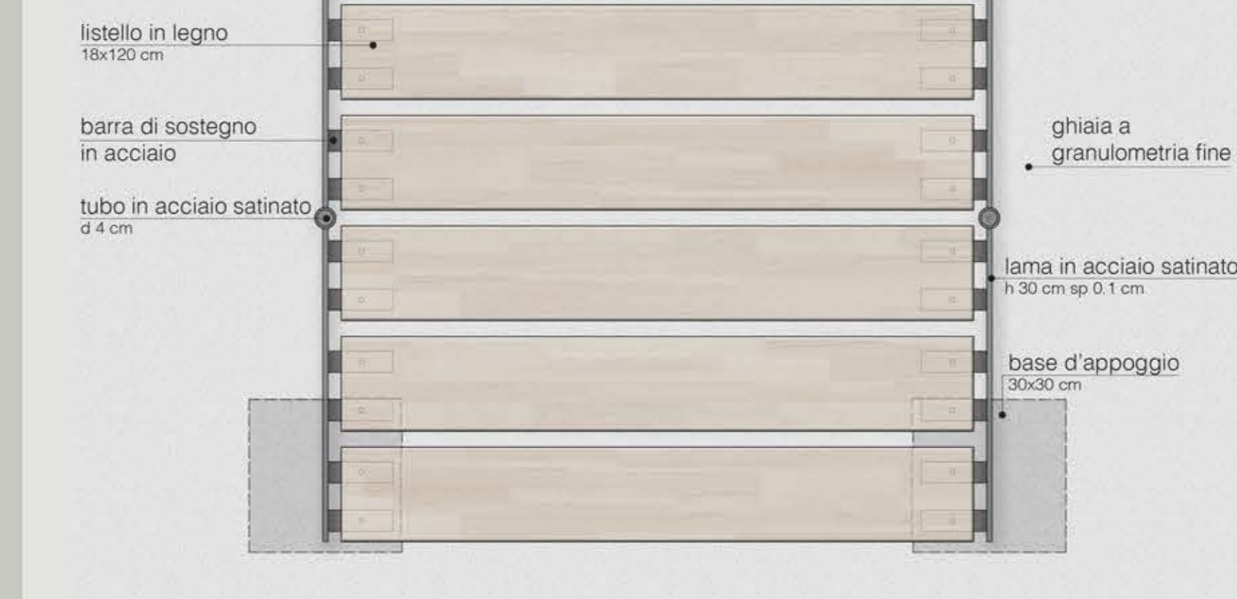
Dettaglio2 . La lama in acciaio che sostiene la passerella in legno è ancorata al terreno tramite elementi d'appoggio a base rettangolare inseriti sotto terra.
