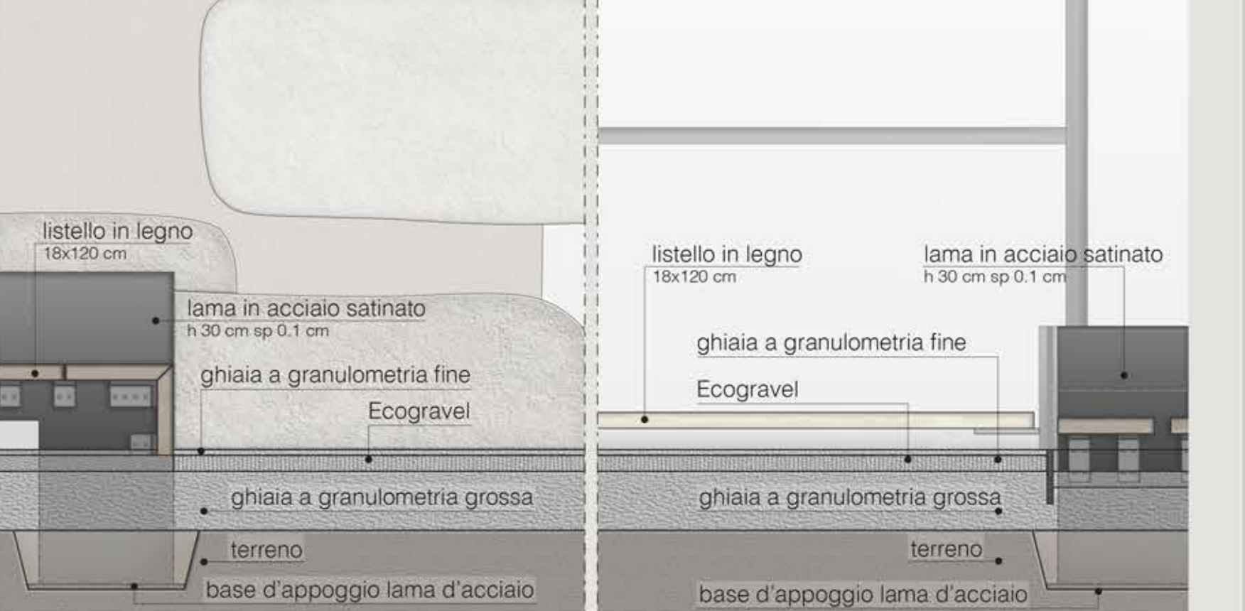
Sezione dd' . Lungo il prospetto ovest una scalinata permette di superare il dislivello morfologico. I gradini sono realizzati tramite il contenimento del terreno attraverso lame di acciaio.
