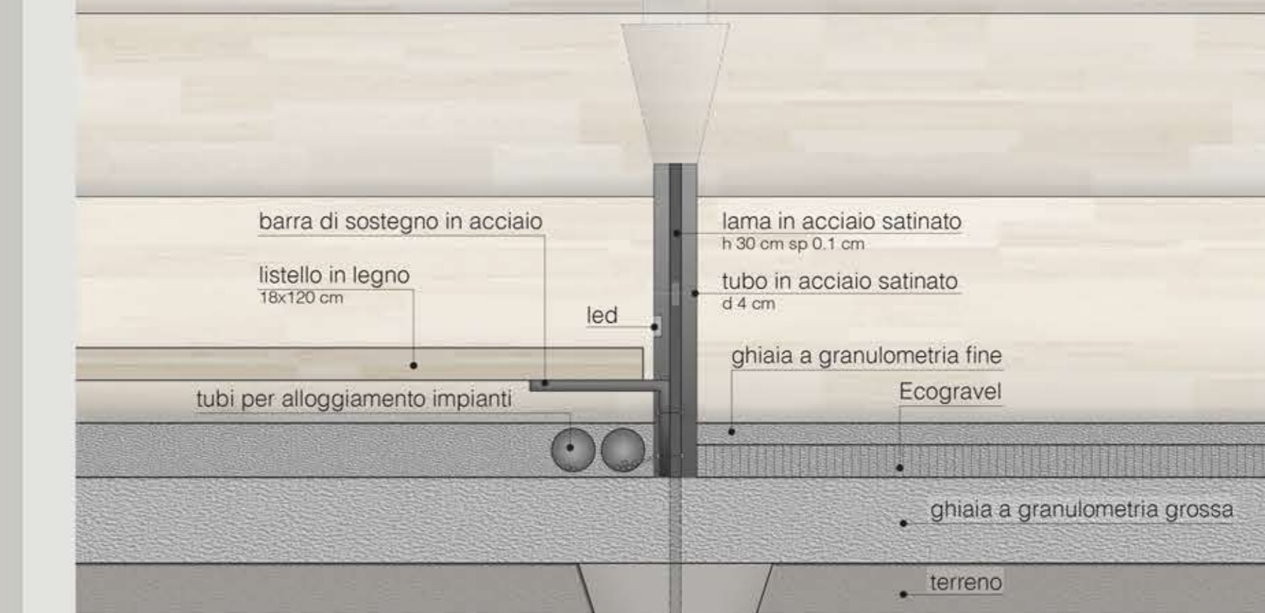
Dettaglio2 . La lama in acciaio che sostiene la passerella in legno è ancorata al terreno tramite elementi d'appoggio a base rettangolare inseriti sotto terra.
