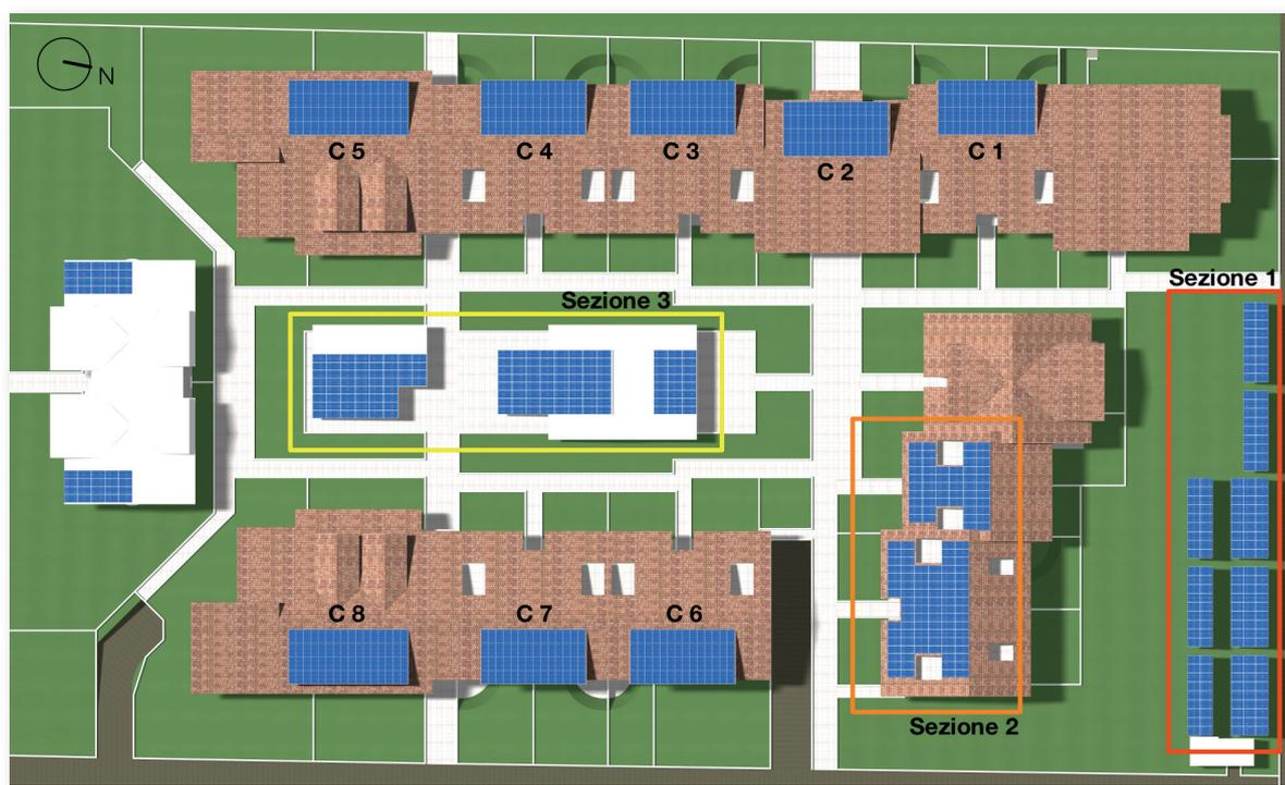
**Immagine 3.13:** Impianto Fotovoltaico: disposizione dei sistemi fotovoltaici.
