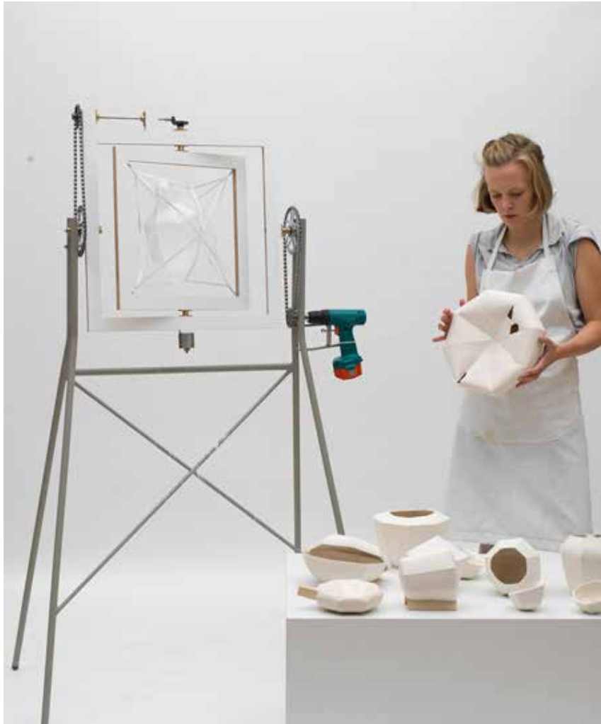
IMG 91 The Improvisation machine by Annika Frye, 2013 La macchina è fondamentale. La designer parte con l'obiettivo di riprodurre una produzione di tipo industriale all'interno del suo atelier. Utilizzando un polimero che non ha bisogno di ulteriori lavorazioni, ottiene molte forme diverse senza la creazione di uno stampo troppo costoso.
