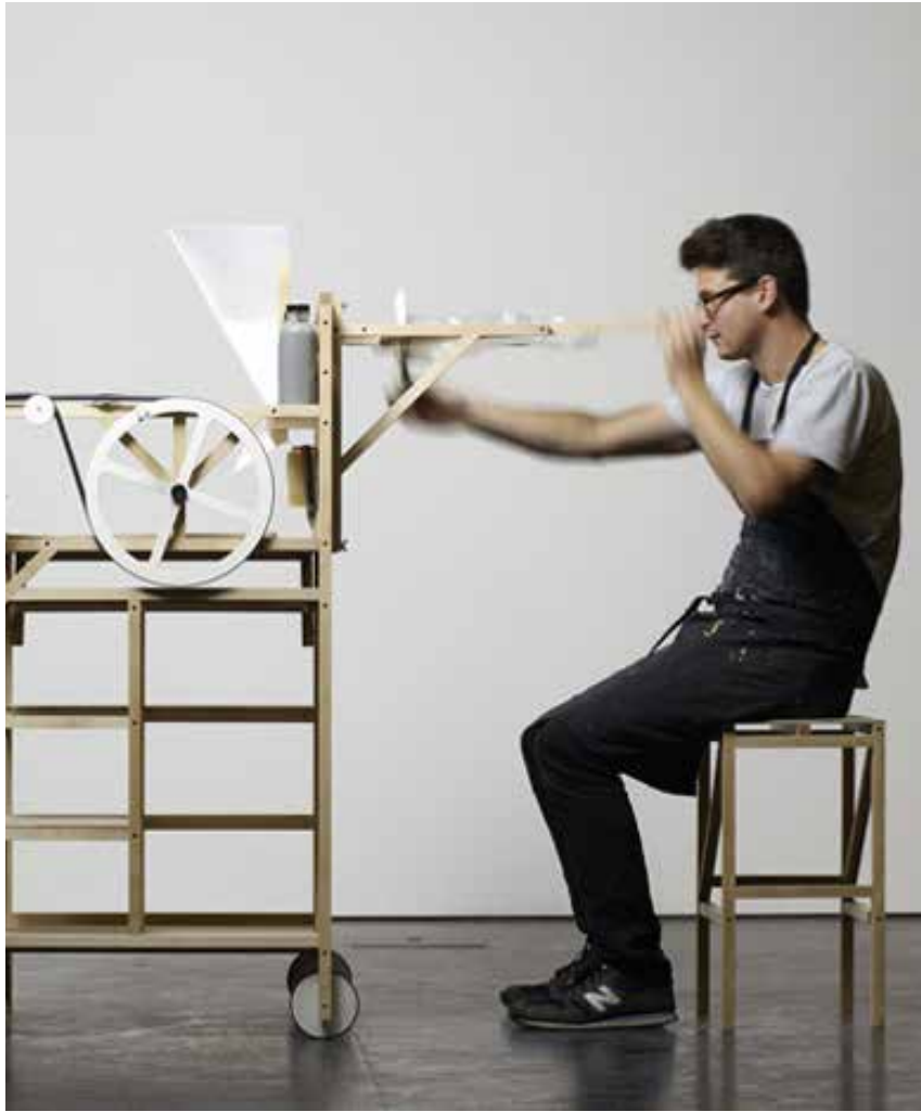
IMG 95 Faceture machine and vases by Phil Cuttance, 2012 I vasi vengono prodotti utilizzando uno stampo artigianale, in cui viene colato un composto di acqua e resina. La macchina stessa è in vendita.
