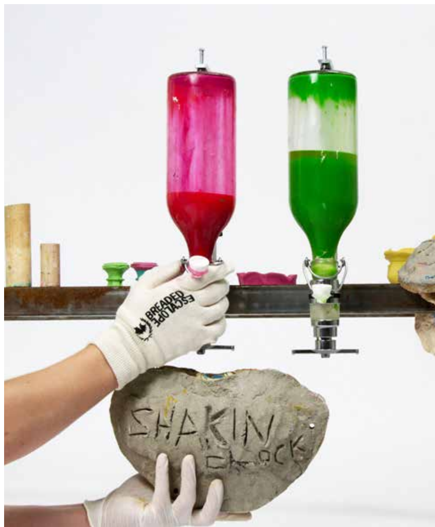
IMG 89 Shaking clock by Breadedescalope, 2010 Resina in bottiglia viene immessa in stampi tramite erogatori. Al fine di curare la resina, si ha la necessità di scuotere lo stampo per uno o due minuti. Si tratta di un processo di produzione tra artigianato e performance art. Anche se il processo utilizza fondamentalmente gli stessi principi che vengono applicati nella produzione industriale di massa, si produce ogni singolo pezzo con lavorazione a basso consumo energetico in un ambiente insolito.
