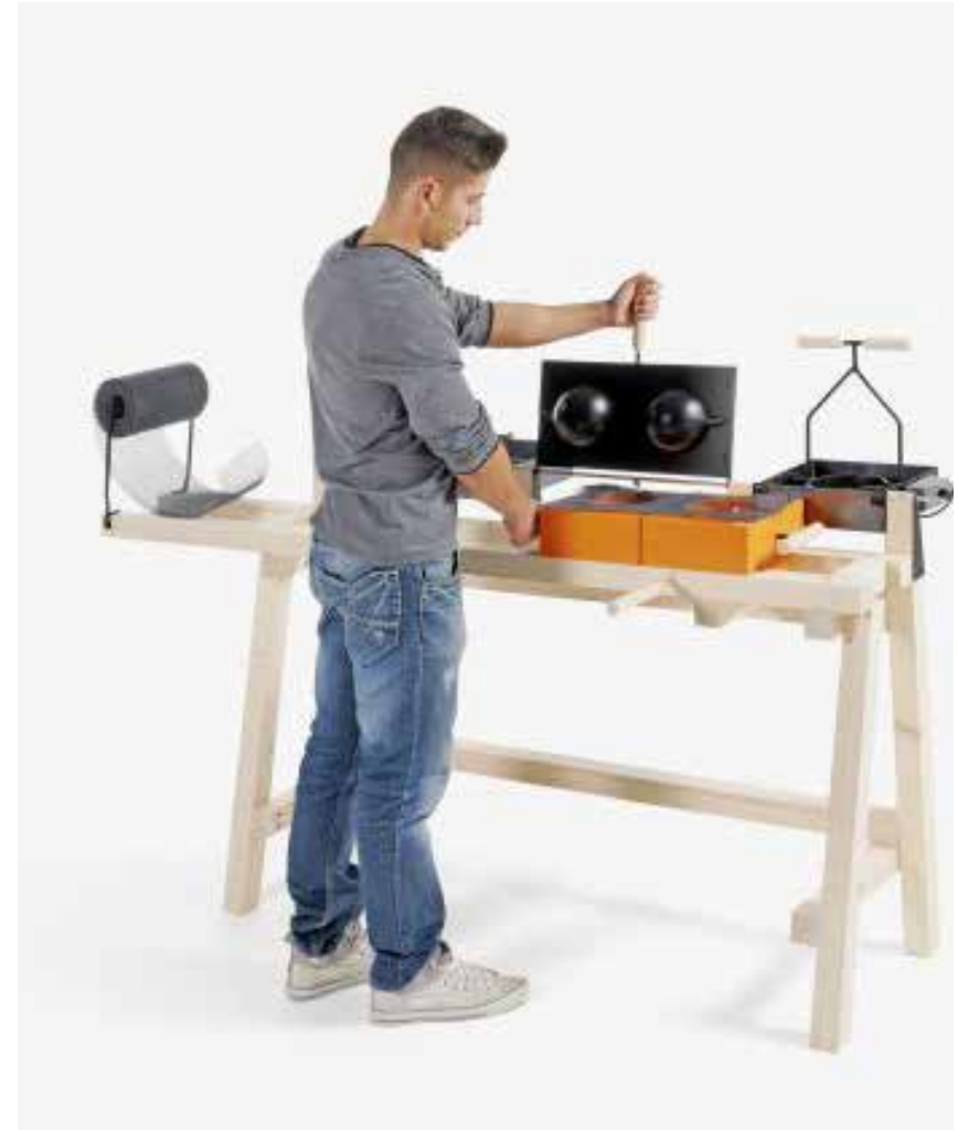
IMG 96 "Stamp" di Anaïs Benoit Dignac, Arthur Didier, Edris Gaaloul della scuola ECAL, 2012 Una linea di produzione che trasforma semplici tralicci di plastica in lampade portatili. Le fasi del processo di produzione sono svolte lungo una rotaia: la plastica è riscaldata, stampata, e infine agganciata ad un bulbo. Il risultato di questa produzione ingegnosa è una lampada portatile.
