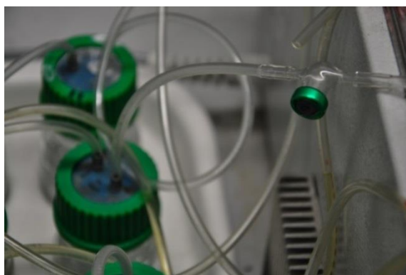
Figura 2.11 Setto per il prelievo del gas nel corso della prova
