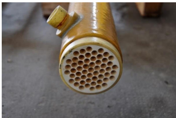
Figura 2.8 Sezione della membrana ceramica installata in combinazione ai reattori di DF e DA
