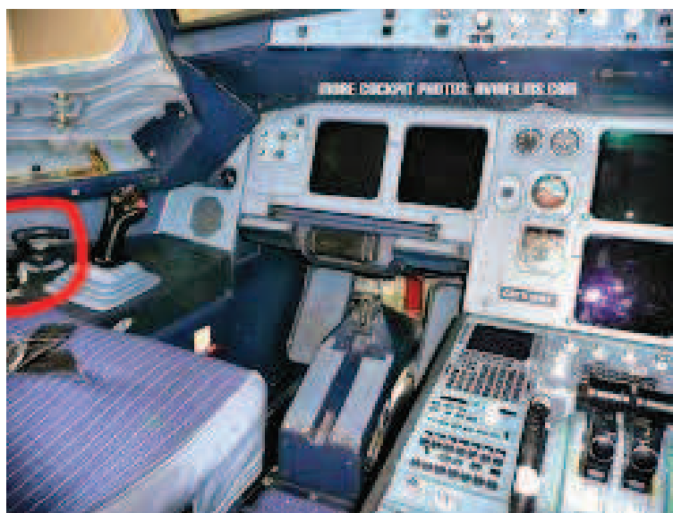
Figura 3.2: Posizione volantino dello sterzo
