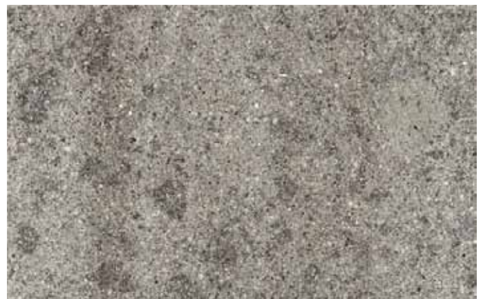
Fig.119 Le macchie nere superficiali del Nenfro sono i cristalli di leucite e ignimbrite presenti nella pietra.
