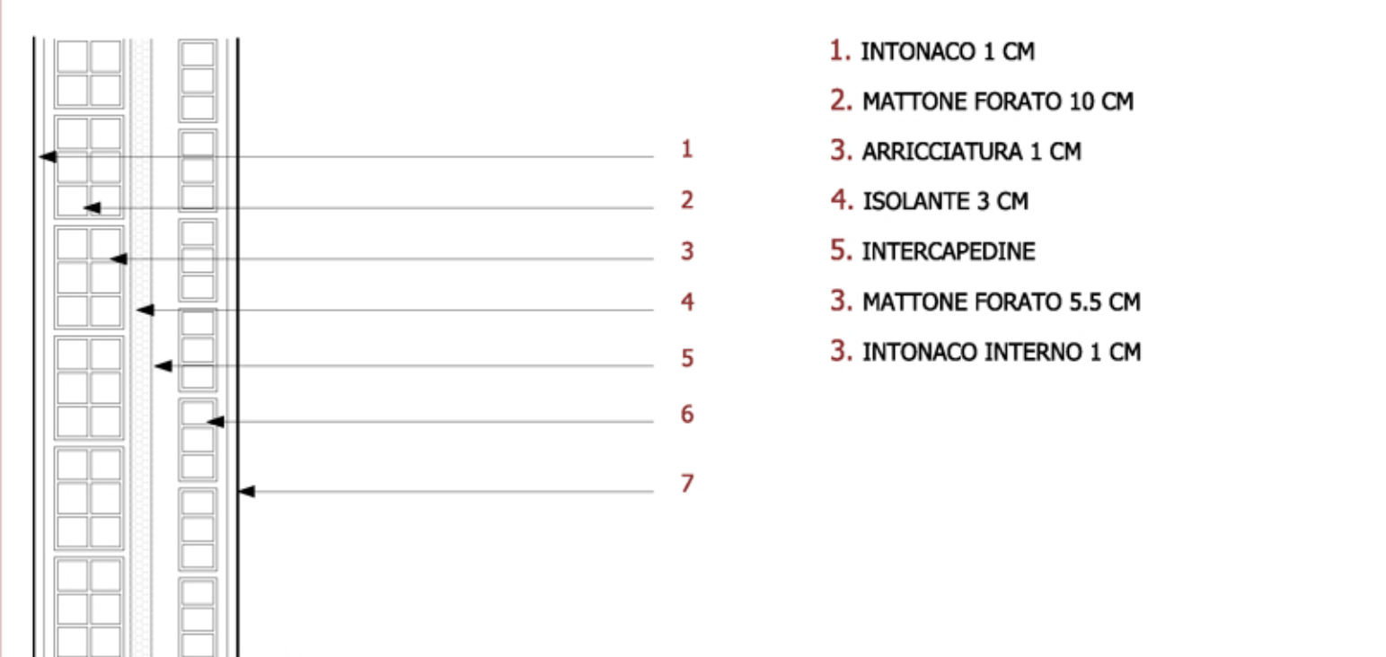
TAMPONATURA ESTERNA CON SUPERFICIE RIFINITA AD INTONACO
