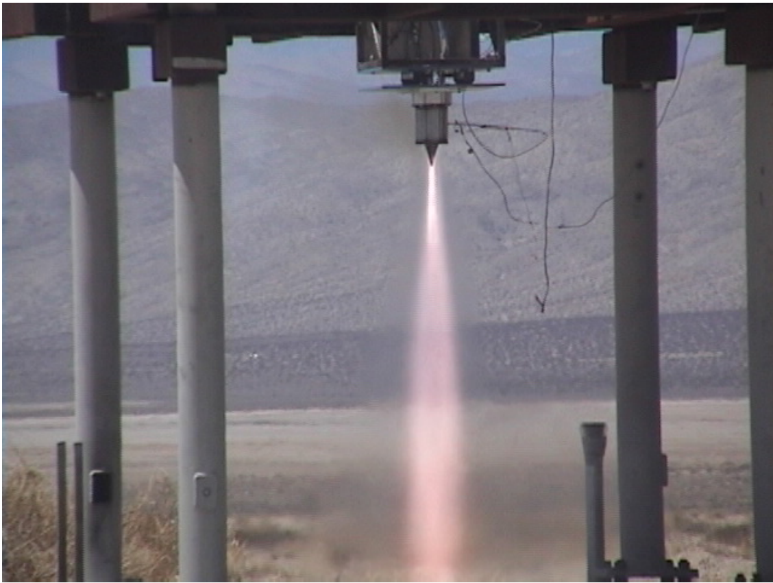
Figura 1.6: Test del motore dotato di aerospike per il progetto CALVEIN della California State University di Long Beach
