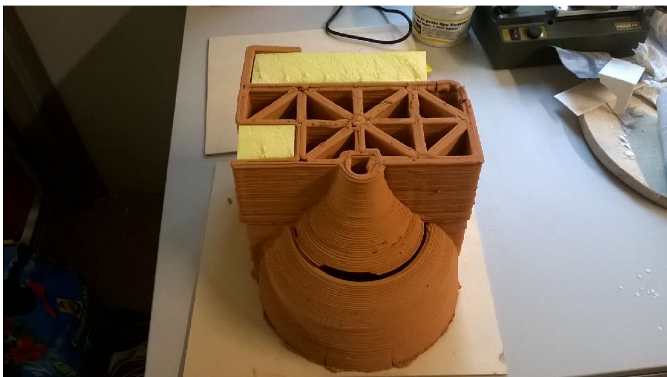
Illustrazione 82: Secondo prototipo realizzato del modulo 1, in particolare con i due sub-componenti realizzati ed assemblati, ivi compreso lo strato coibente
