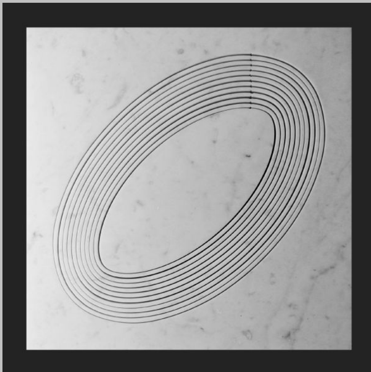
Illustrazione 17: in questa lastra è possibile individuare il punto di partenza del tracciato di ogni taglio e lo spessore del taglio
