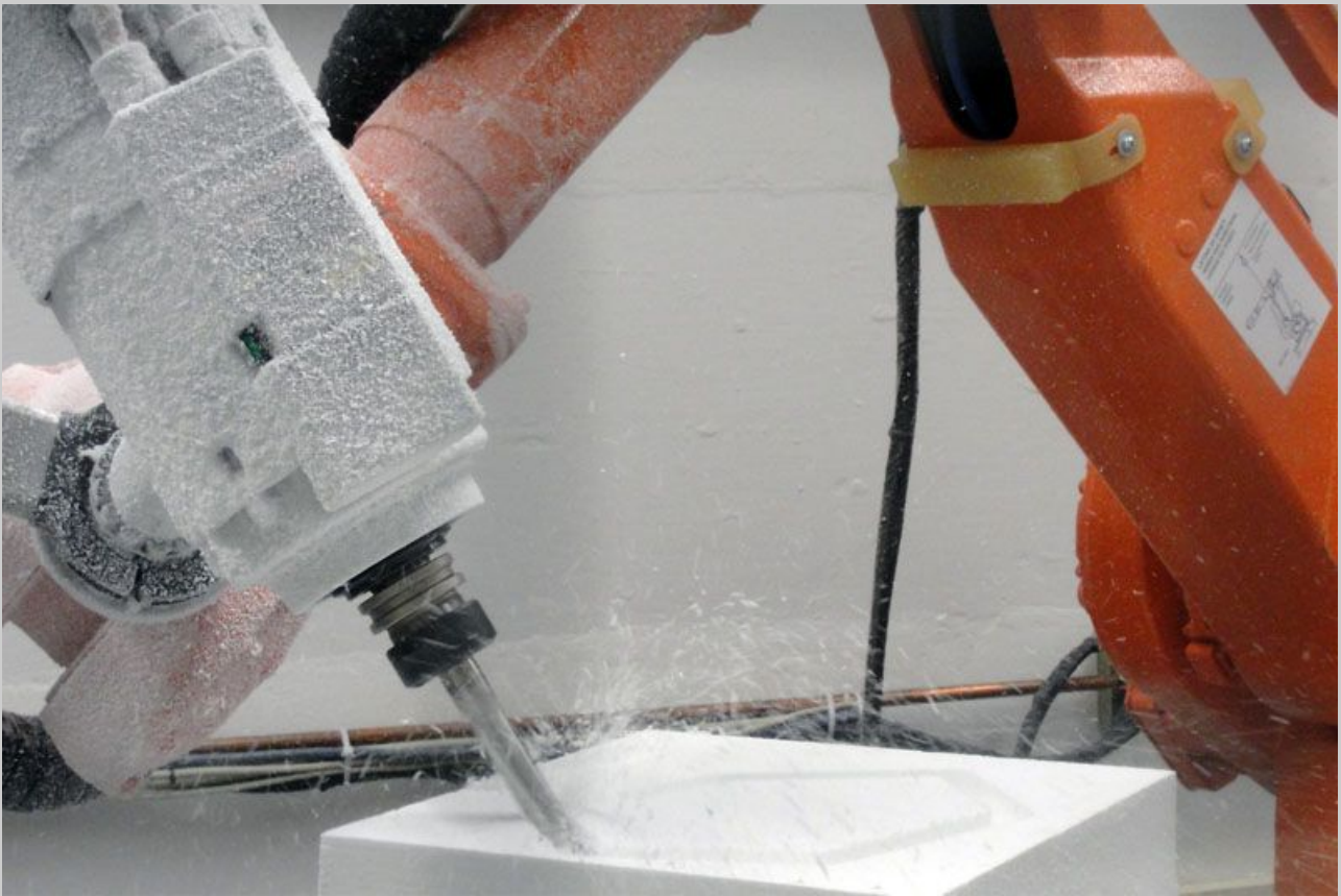
Illustrazione 50: processo di fresatura degli stampi con robot a 7 assi
