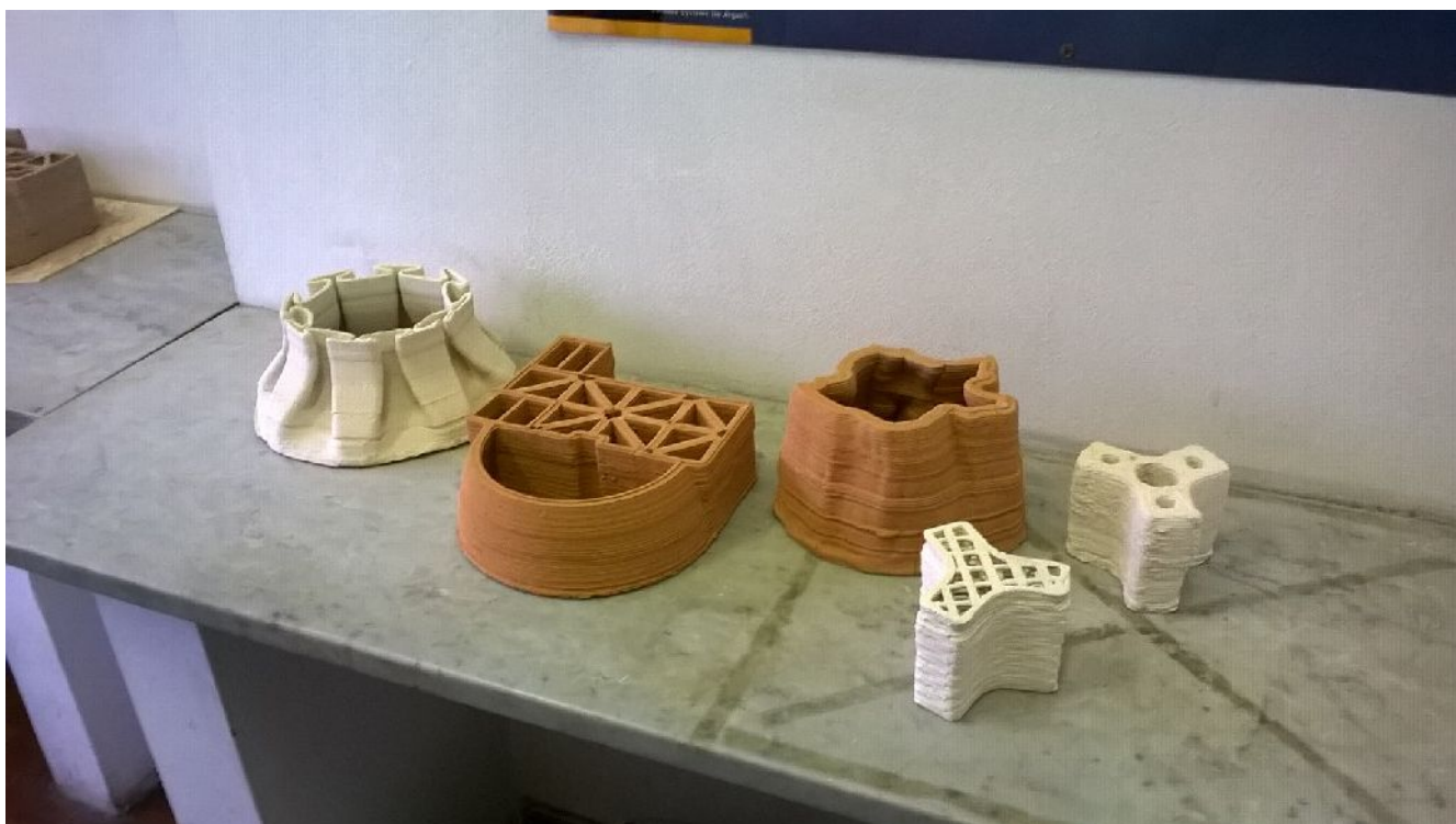
Illustrazione 81: Prototipo del modulo 1 dopo essiccazione e cottura, ed altri moduli realizzati dal Più Lab del Politecnico di Milano
