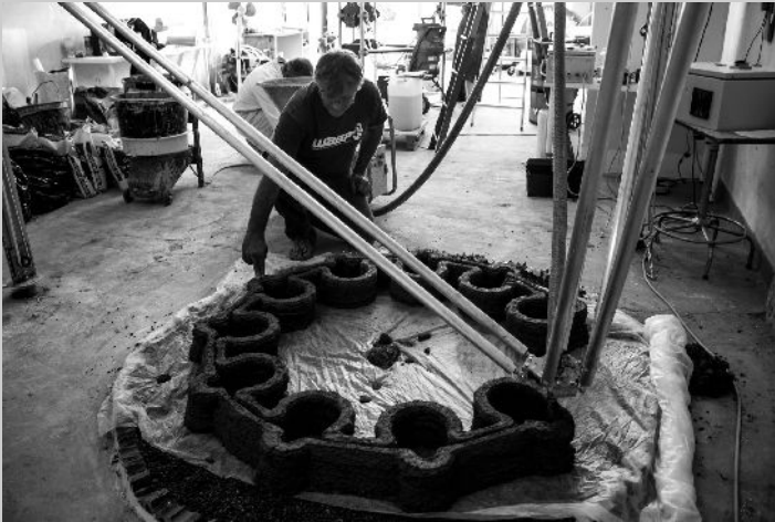
Illustrazione 31: Wasp project durante un stampa 3d in argilla di grande formato
