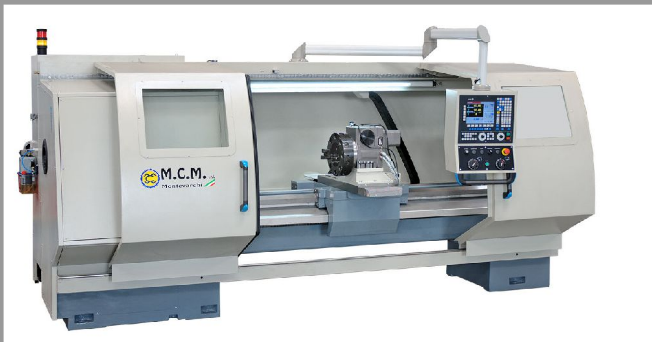
Illustrazione 18: tornio cnc con tipiche barriere di protezione
