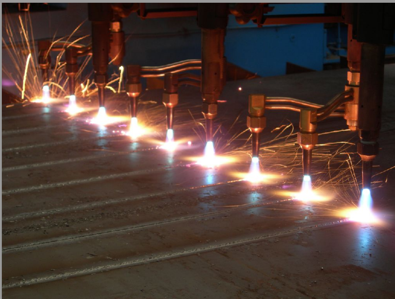
Illustrazione 8: Processo di taglio al plasma con più sorgenti
