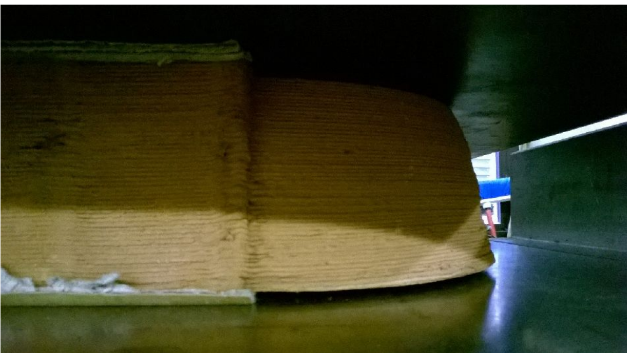
Illustrazione 91: Particolare che evidenzia l'adesione nella sola porzione con cartone interposto
