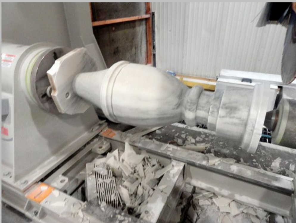
Illustrazione 19: lavorazione per tornitura cnc di un elemento statuario tradizionale
