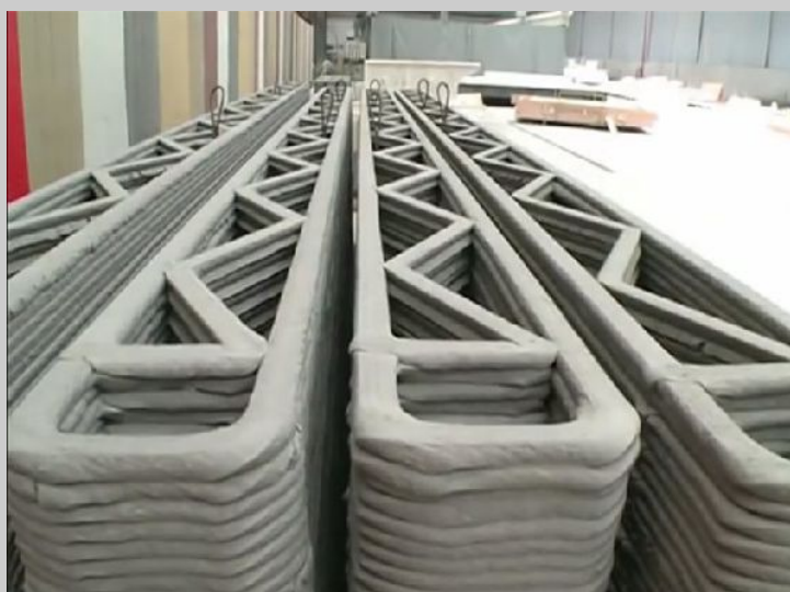
Illustrazione 41: Sezioni parziali realizzate con stampa 3d per CLS
