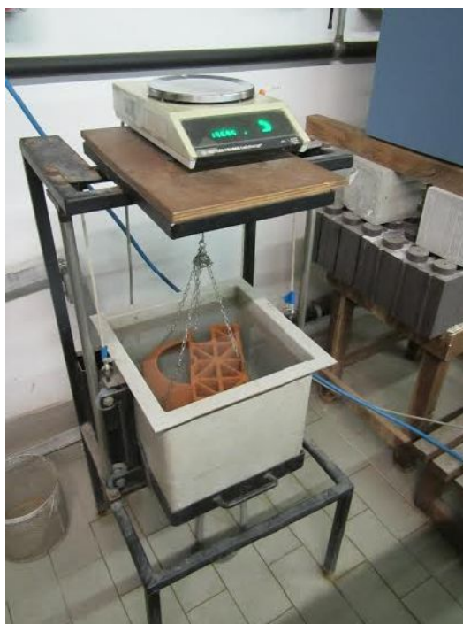
Illustrazione 96: il sistema permette una pesata idrostatica ovvero con il campione completamente immerso in acqua
