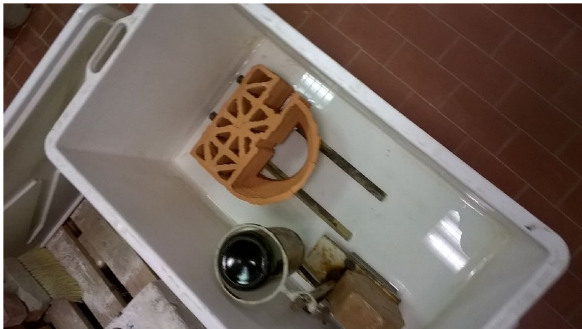
Illustrazione 100: inserimento del campione in vasca con livello di acqua costante tramite supporto di appoggio
