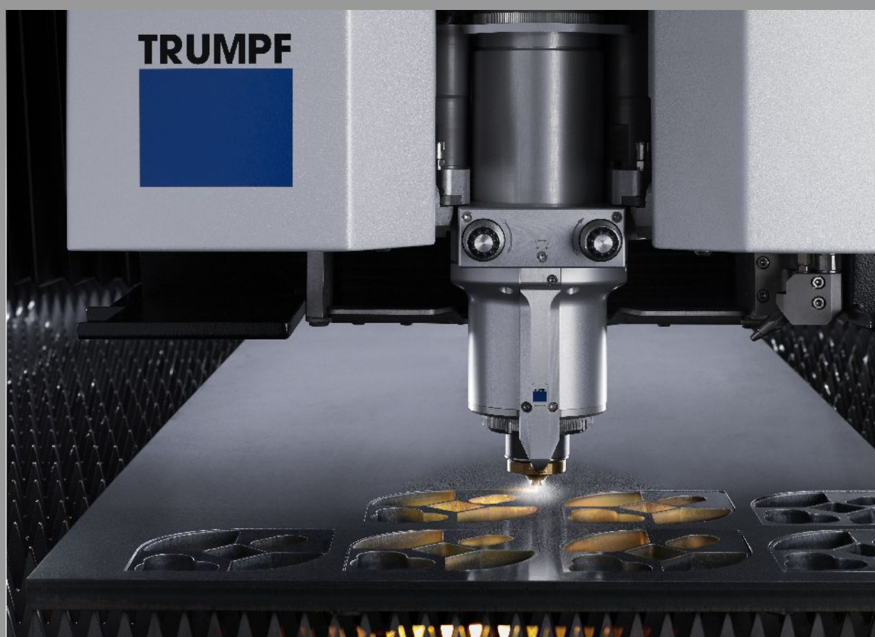
Illustrazione 6: sorgente laser durante il processo di taglio di una lamiera
