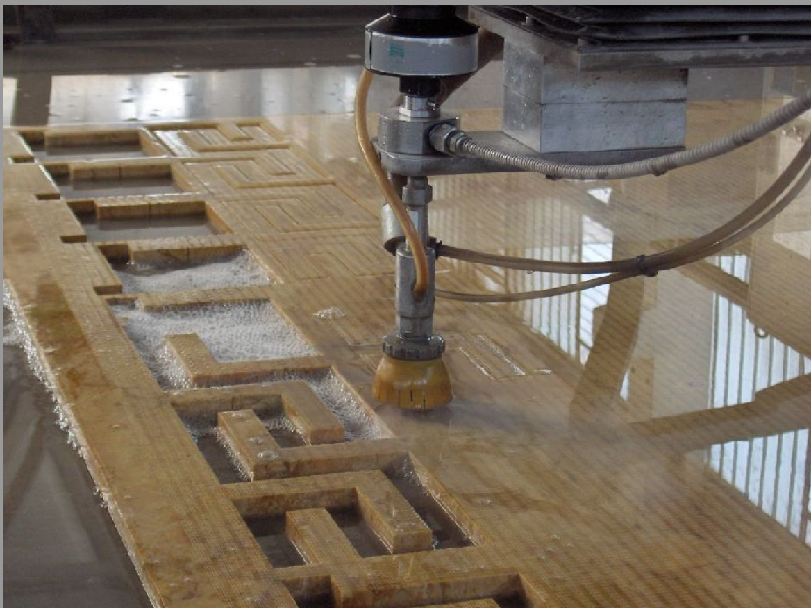
Illustrazione 16: water jet in azione su materiale lapideo
