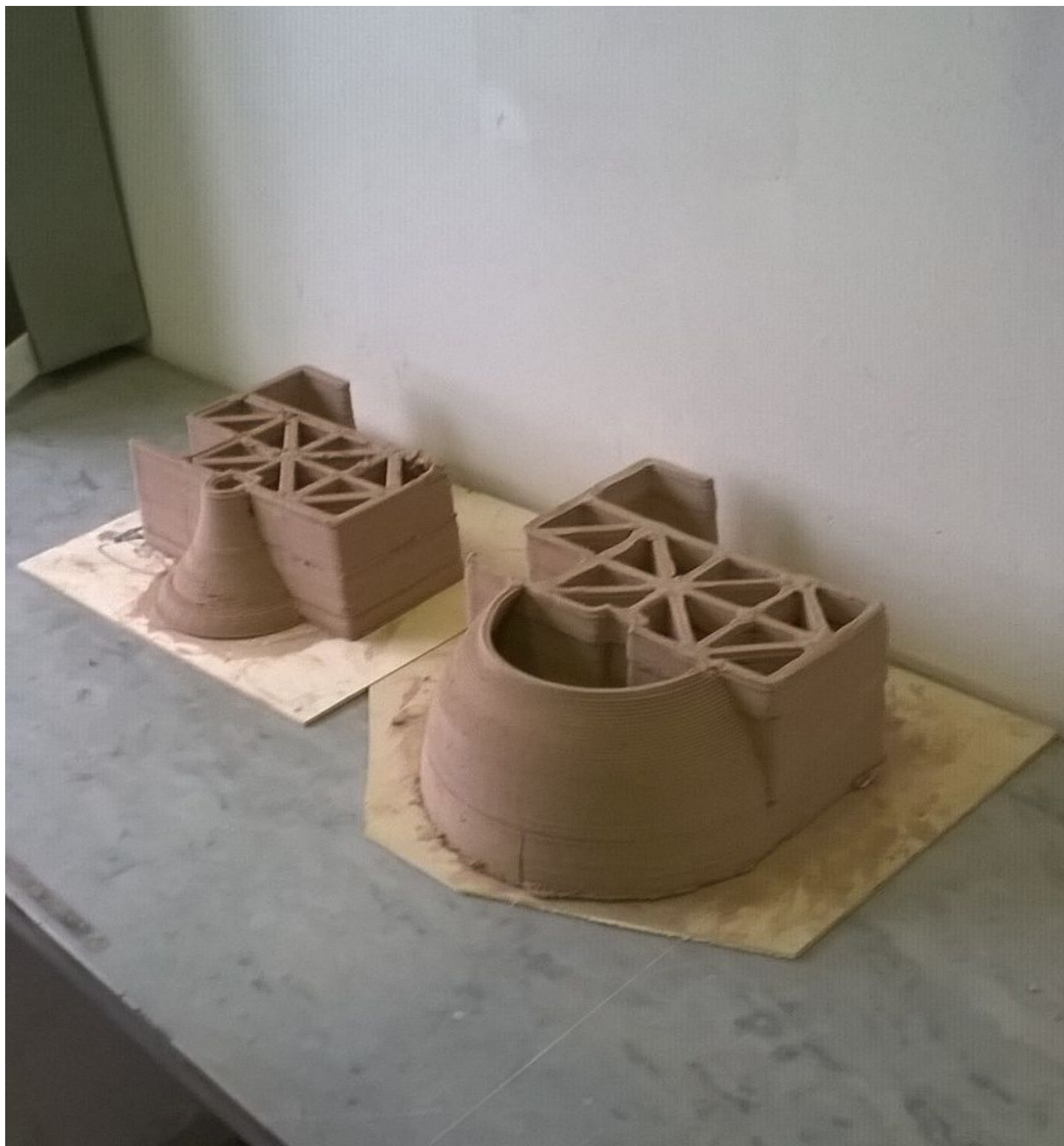
Illustrazione 80: Prototipo del modulo 1 realizzato in due sob-componenti, durante il processo di essiccazione
