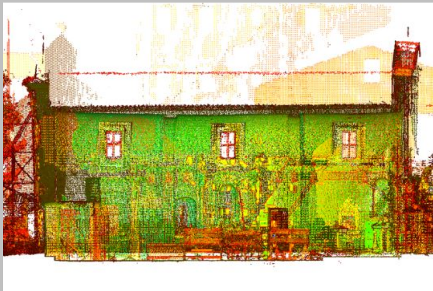
Illustrazione 22: esempio di scansione 3d per un rilievo architettonico
