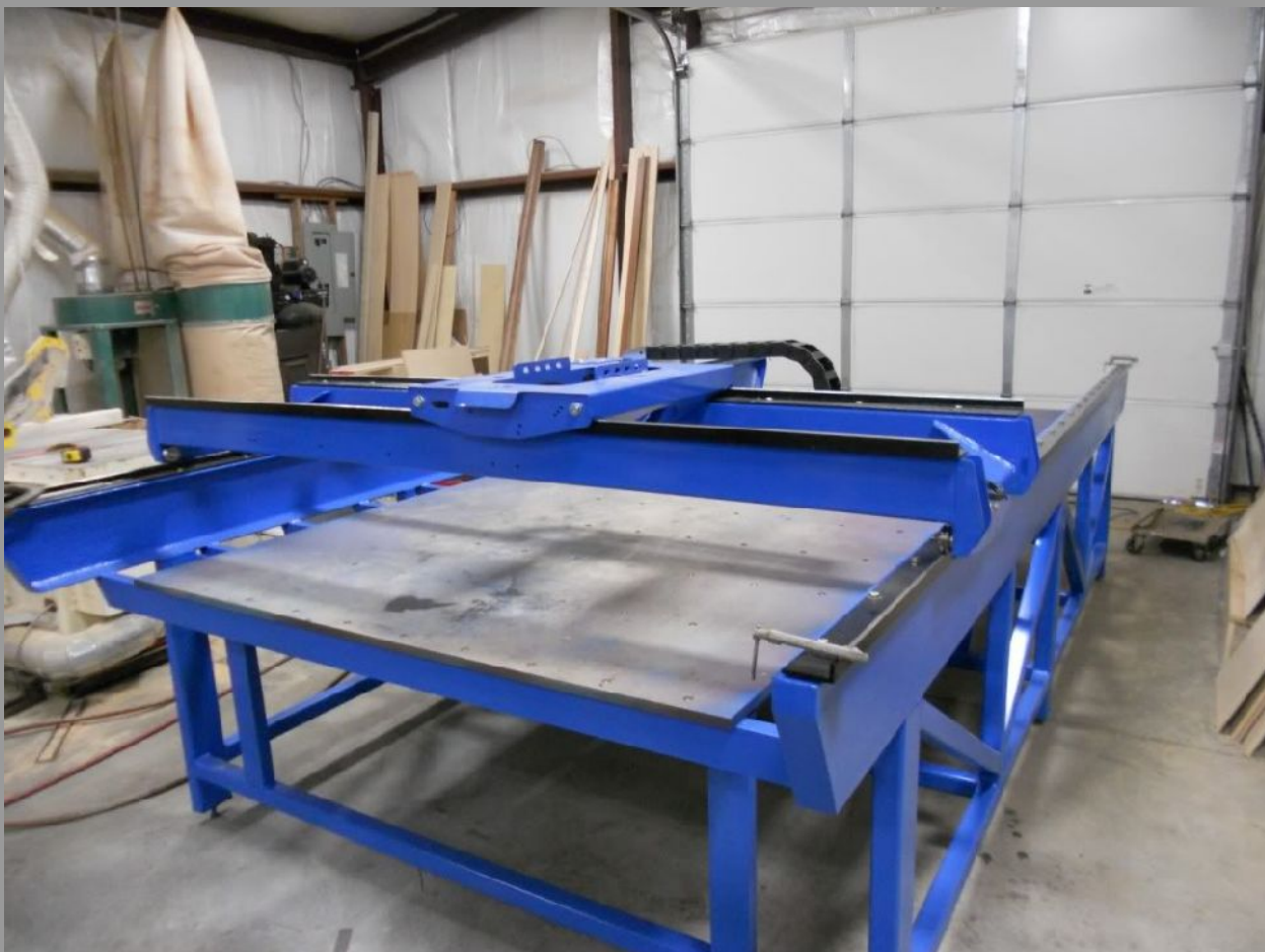
Illustrazione 12: Tipica fresa a controllo numerico a 3 assi per pannelli
