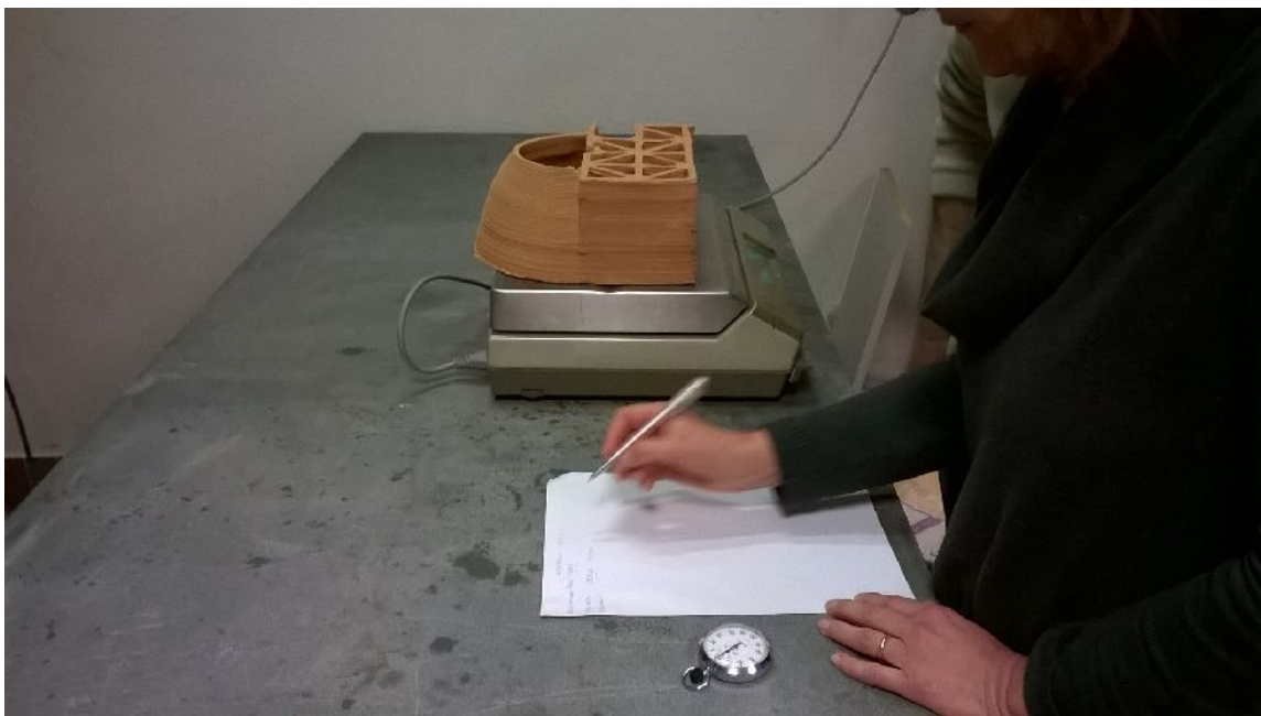
Illustrazione 95: pesatura su bilancia elettronica e scrittura dei valori su report cartaceo
