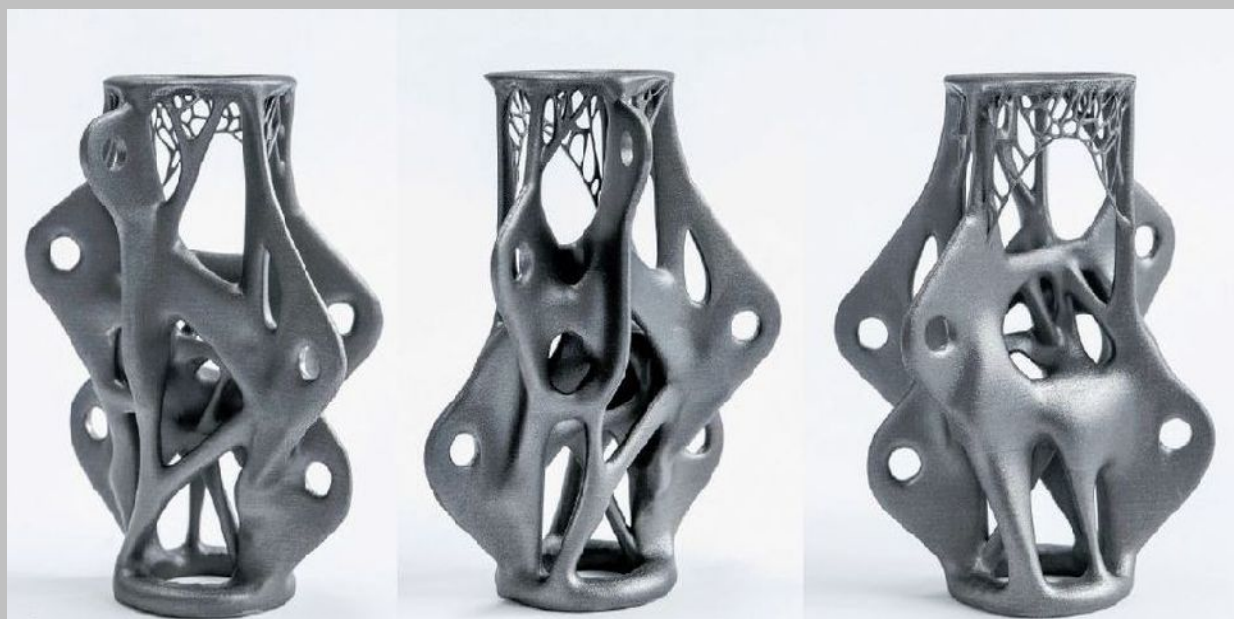
Illustrazione 5: Varie fotografie del prototipo realizzato, è stato realizzato un design parametrico generativo con i vincoli geometrici imposti dal progetto strutturale
