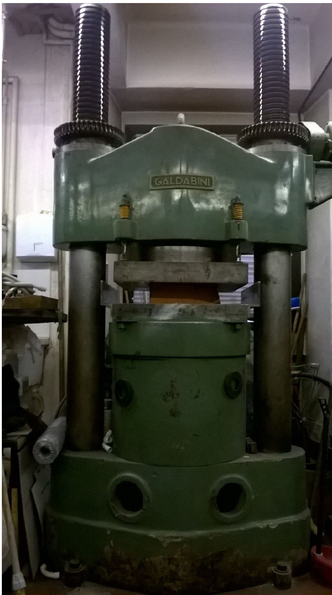
Illustrazione 92: Pressa idraulica marca Galdabini, degli anni '60 utilizzata per le prove di carico
