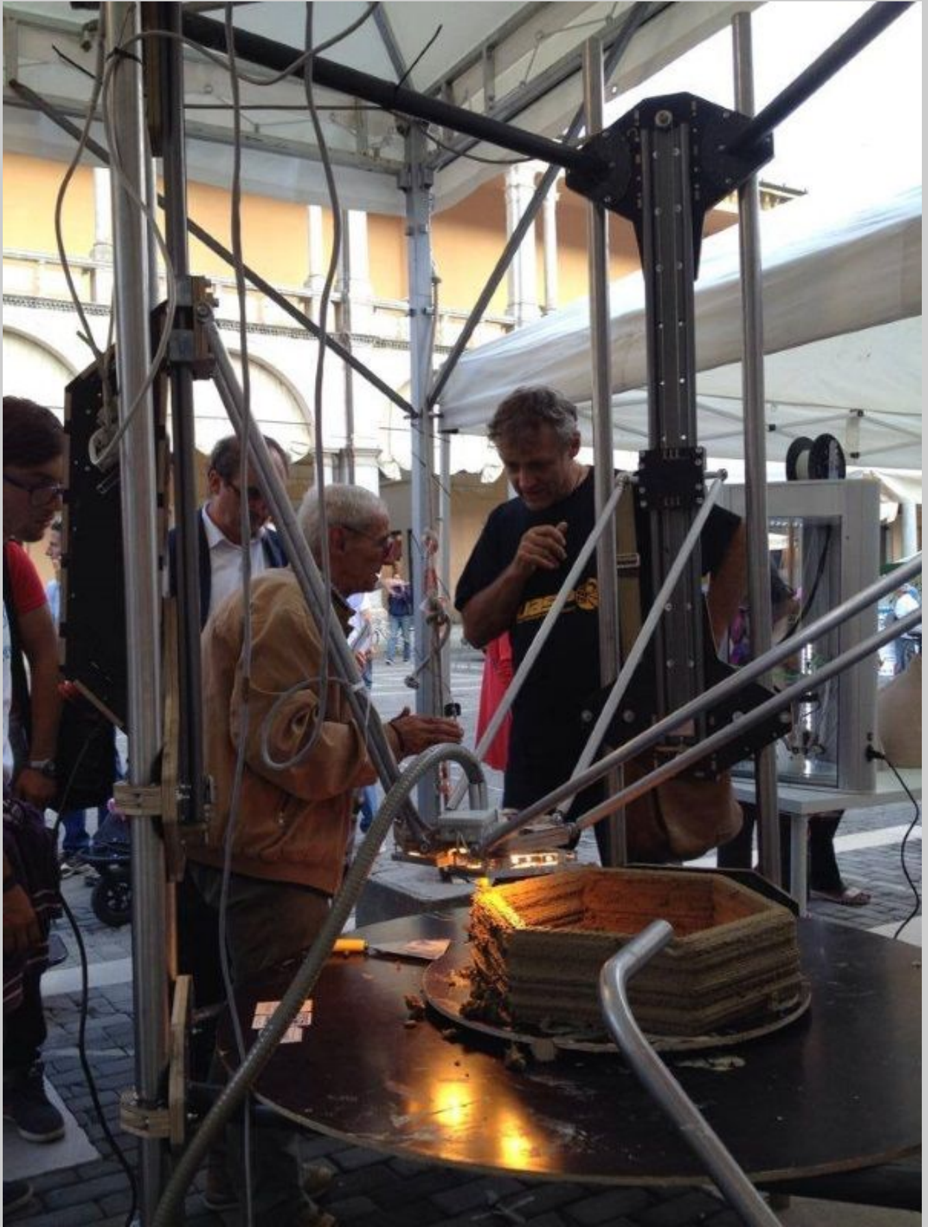
Illustrazione 33: Wasp projet durante il processo di stampa 3d per argilla
