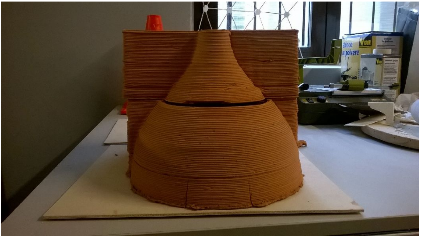
Illustrazione 83: vista frontale del secondo prototipo realizzato
