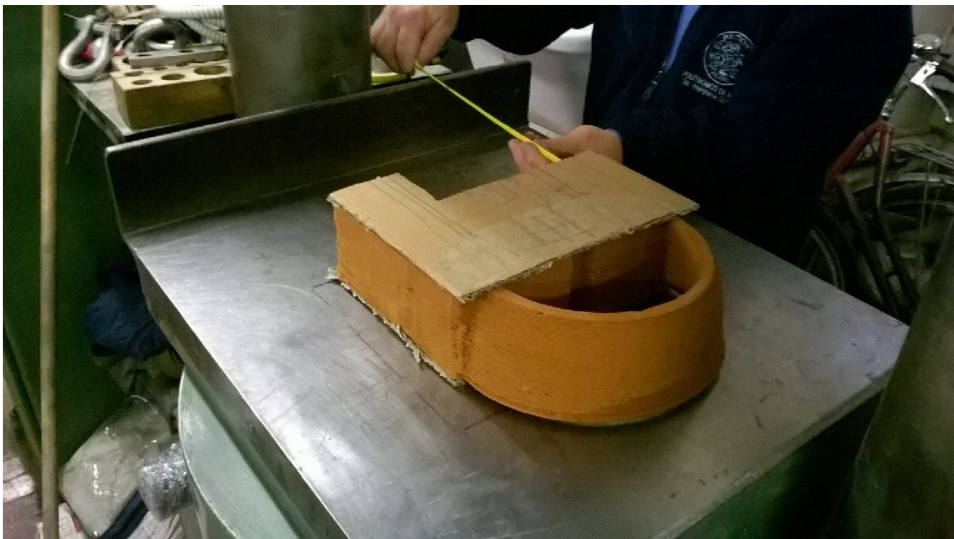
Illustrazione 87: posizionamento del prototipo 1 nella pressa idraulica con materiale di cartone interposto
