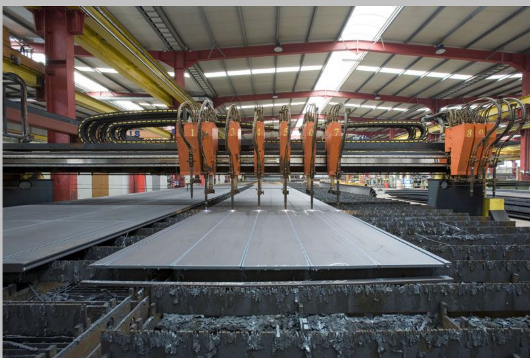
Illustrazione 10: lavorazione di lastra con plasma a più sorgenti
