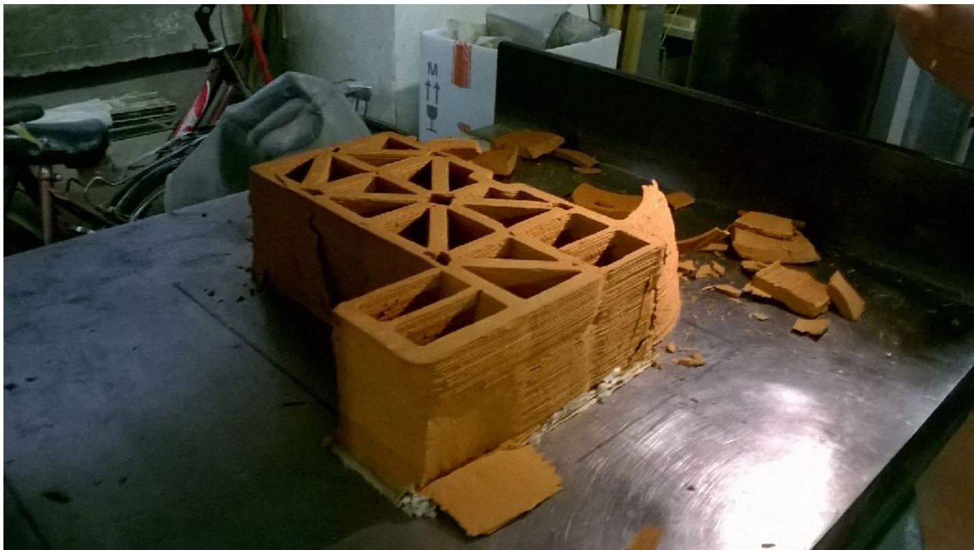
Illustrazione 93: Prototipo 1 frantumato dopo la prova di carico
