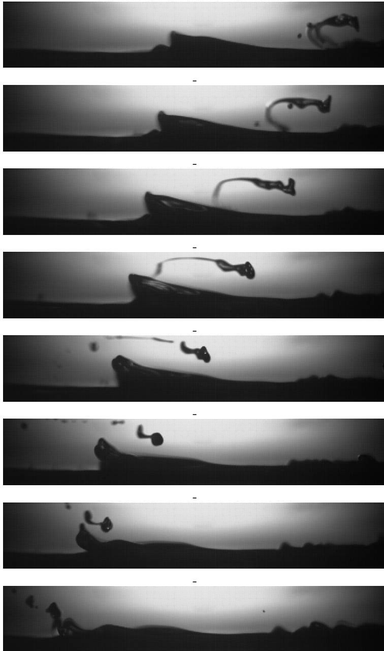
Figura 68: dinamica reale per una struttura tozza. Il diametro della goccia che si forma è di circa 300 \mu\text{m} . Lo strato liquido è paraffina pura. La velocità media del flusso è di 18\text{m/s} .
