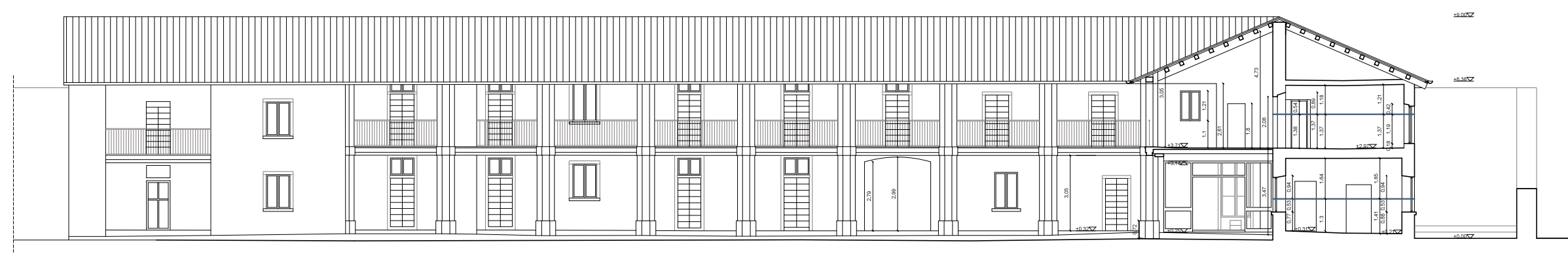
Sezione AA- scala 1:200 Rilievo eseguito a scala 1:100
