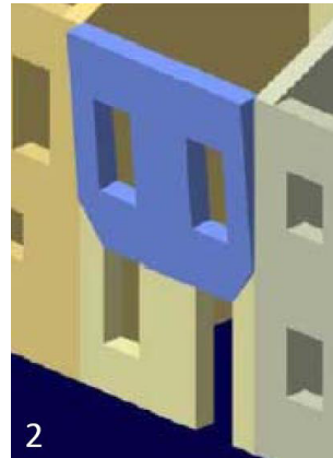
Figura 6.2: Ribaltamento semplice di parete monolitica all'ultimo piano.
