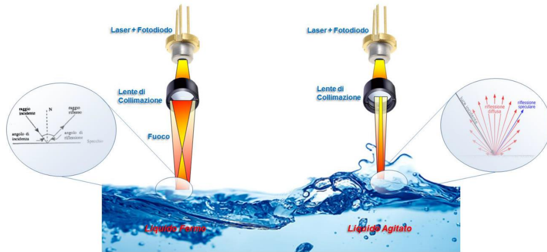
Figura 9.11 Configurazioni ottiche: fuoco prima e dopo il bersaglio.
