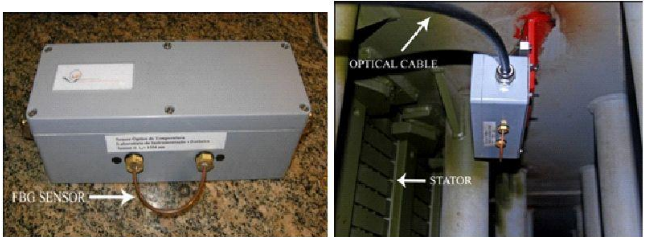
Figura 6.11 Scatola contenente il sensore FBG a sinistra; a destra il sensore installato.
