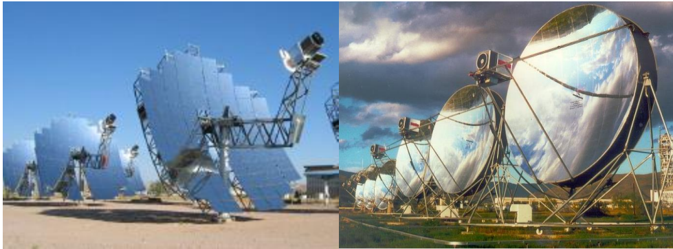
Figura 15: Collettori a disco solare con motore Stirling [4].
