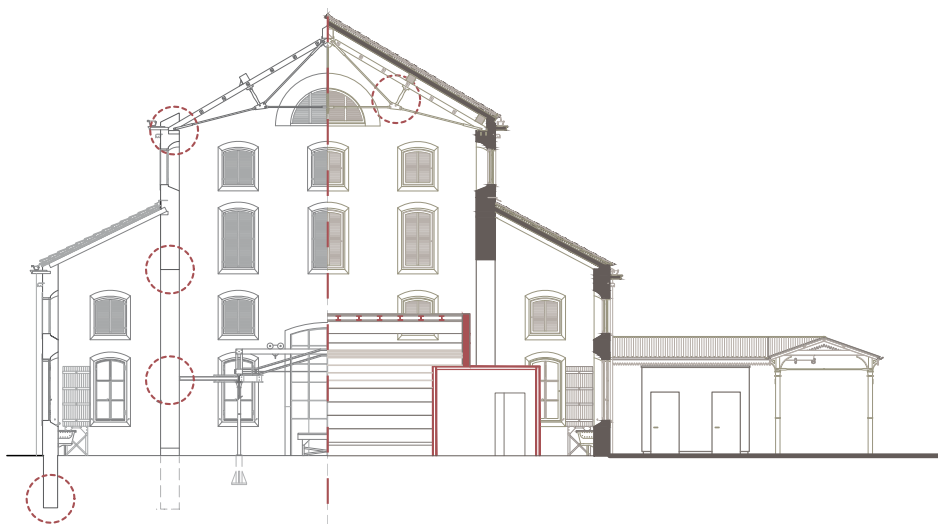
Sezione trasversale dell'edificio, metà edificio storico e metà edificio di progetto. In evidenza i punti critici che sono stati studiati nei paragrafi successivi.
