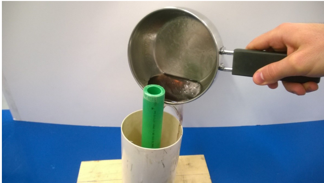
Figura 21 realizzazione pratica braccio prova: colata della gelatina
