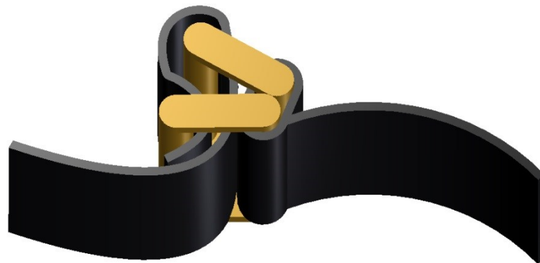
Figura 78 funzionamento della chiusura ad attrito nel prototipo 2
