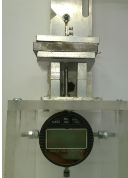
Figura 53 setup di misura per verificare il creep a deformazione imposta
