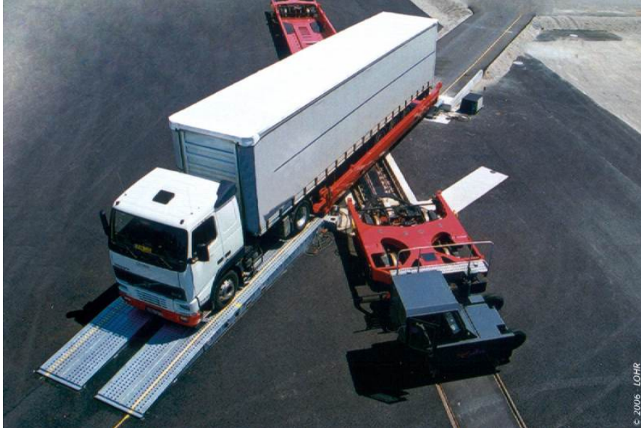
Figura 5.15.D – Carro speciale con piano di carico rotante (sistema Modalohr). Fonte: [48]
