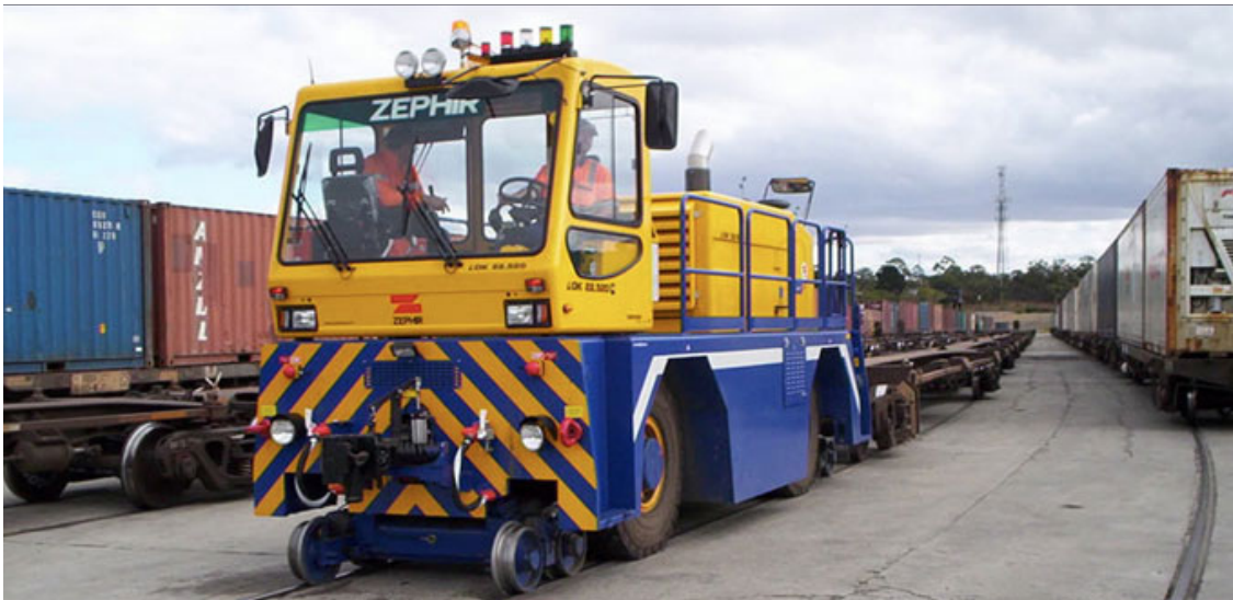
Figura 5.3.C – Locotratore da manovra. Fonte: [39]
