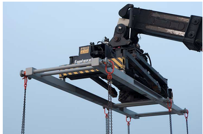
Figure 5.15.H-5.15.I – Telaio rettangolare connesso allo spreader . Fonte: [50]
