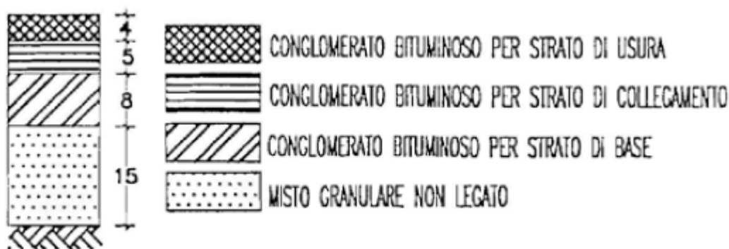
Figura 5.12.M – Pavimentazione flessibile per il parcheggio dipendenti
