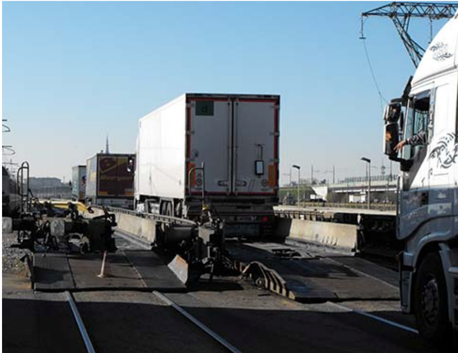
Figura 5.15.K – Autoarticolati dell’Autostrada Viaggiante durante il caricamento. Fonte: [51]
