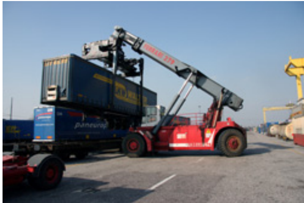
Figura 5.3.A – Gru semovente. Fonte: [5]
