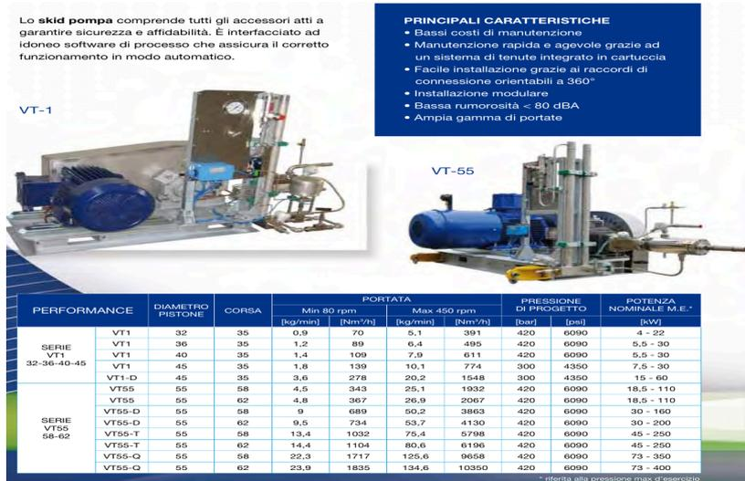
Figura 3.9: Scheda tecnica di due tipi pompa criogenica: la VT-1 e la VT-55. Fonte: Vanzetti Engineering S.R.L.
