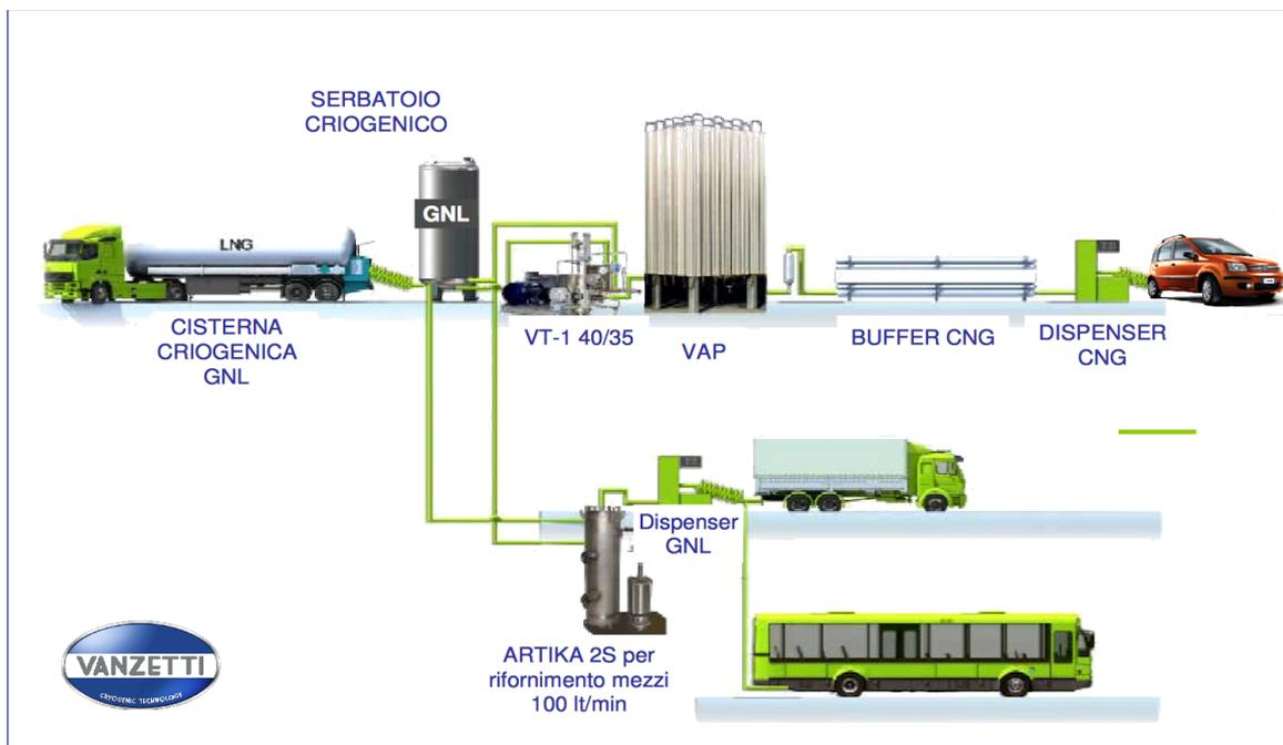
Figura 3.15: Schema d'impianto 2 della "Soluzione GNL". Fonte: Vanzetti Engineering S.R.L.
