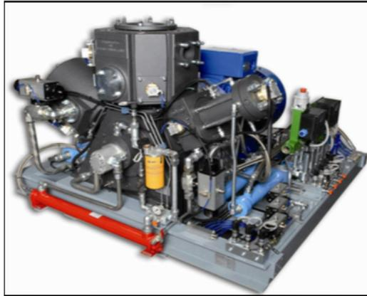
Figura 3.3: Compressore meccanico
