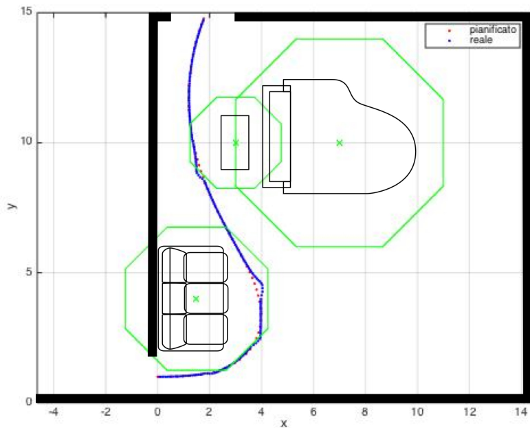
Figura 4.23: Test su ambiente verosimile: Inseguimento di traiettoria
