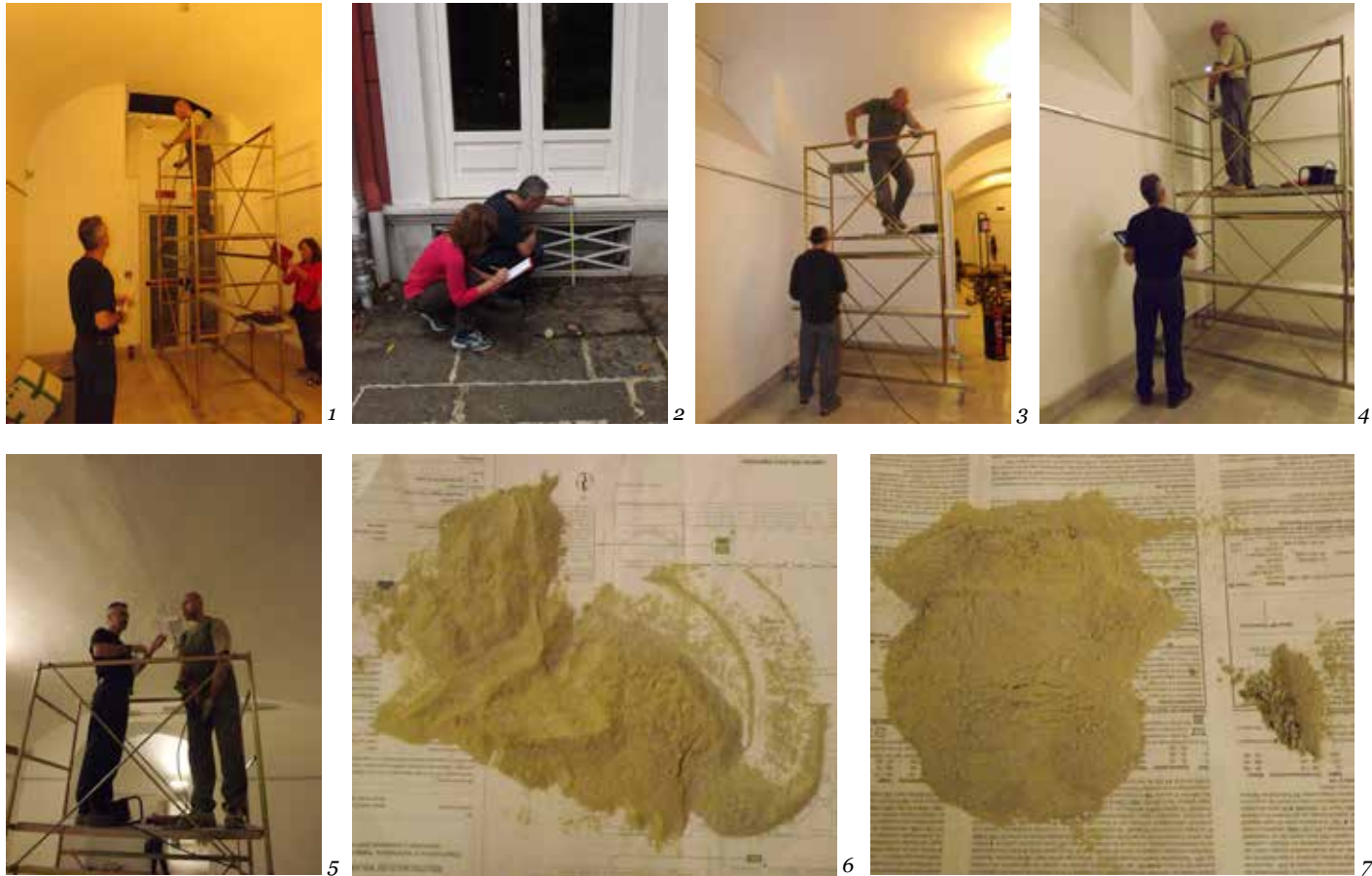
4.25. Fotostoria del rilievo dello spessore del solaio dalla sala I9 e delle diverse fasi dell'indagine con endoscopio nella sala I10: rilievo dello spessore del solaio, con misurazione dell'altezza dal livello di calpestio del seminterrato alla bocca di lupo (1) e successiva distanza dalla bocca di lupo al livello di calpestio del piano rialzato (2); quindi montaggio del ponteggio (3), ispezione con endoscopio del foro all'imposta della volta (4), esecuzione del foro in chiave (5), materiale raccolto all'imposta (6), con le due diverse colorazioni di tufo, e in chiave (7), con i due diversi tufi e il sottofondo del pavimento sulla destra.
