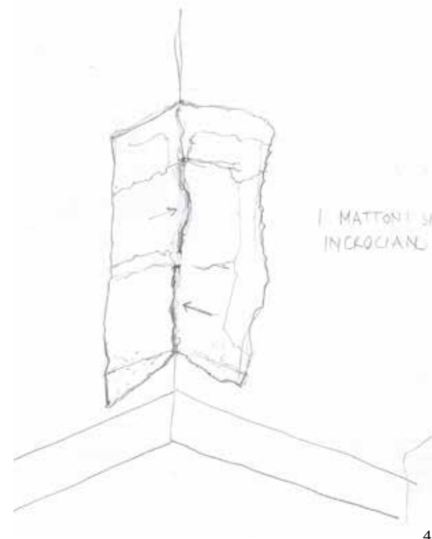
4.24. Verifica Ammortamento I10: localizzazione (1), immagine reale (2), elaborazione grafica (3), schizzo di cantiere (4). Si può notare la perfetta corrispondenza tra i corsi di blocchi di tufo e l'altrettanto corretto incastro.
