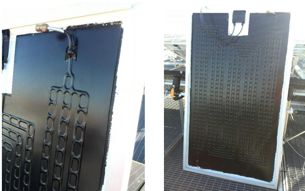
Figura 3.5 - Dettaglio dello scambiatore roll-bond del pannello di 1° generazione
