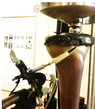
Figura 3.11: posizionamento dell'LVDT per le prove a fatica
