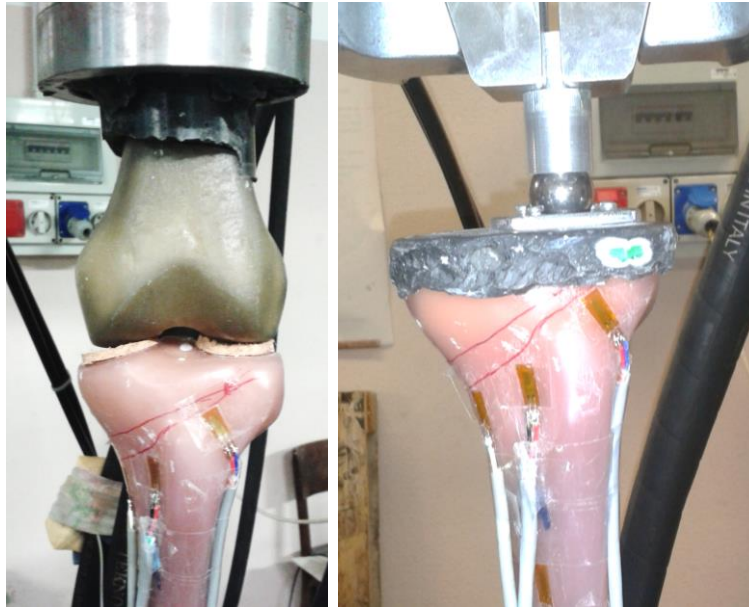
Figura 4.2: Prove effettuate nelle diverse configurazioni sull'osso integro
