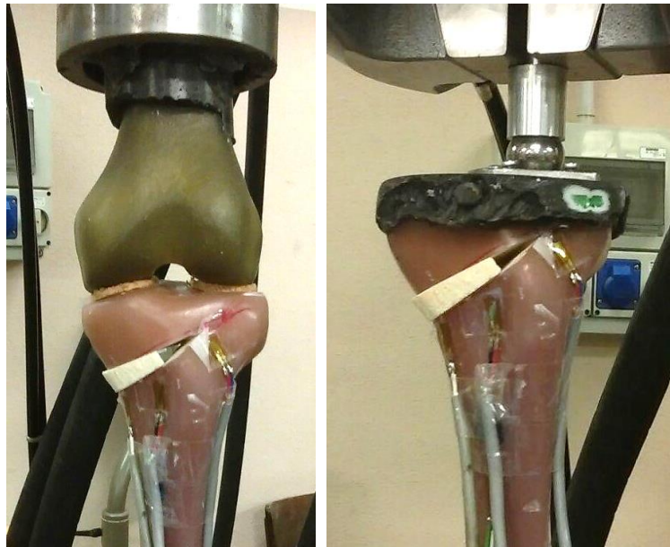
Figura 4.4: Prove realizzate nelle due diverse configurazioni sull'osso fratturato con inserito il cuneo di SmartBone®
