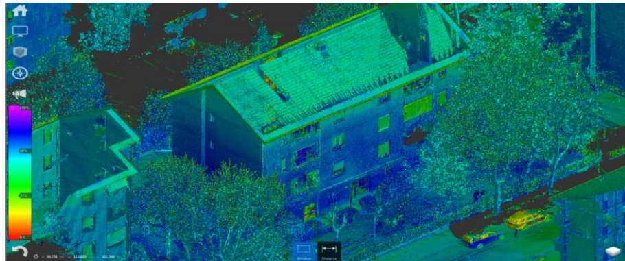
Figura 3.12, Modellazione 3D con rilievo laser scanning, vista sud ovest. Fonte Politecnico di Milano, Polo Territoriale di Lecco
