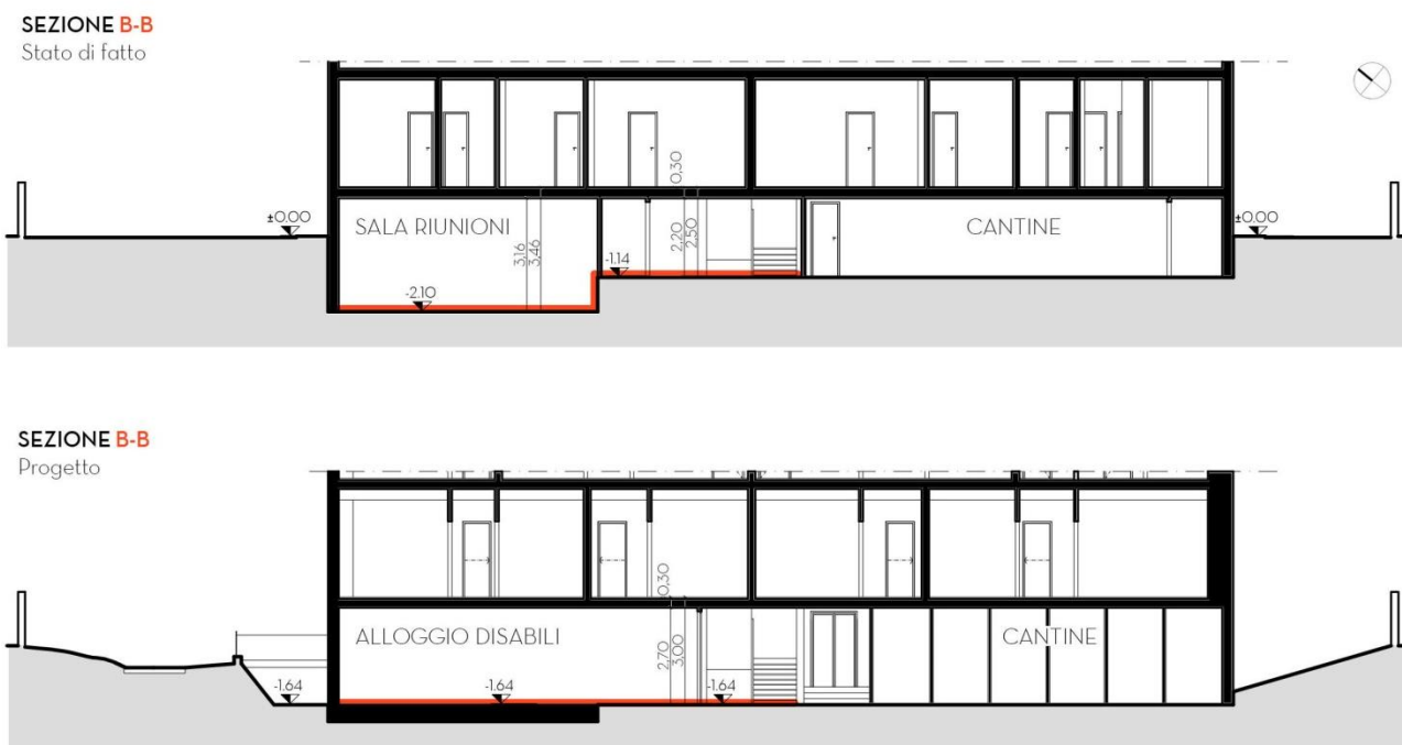
Figura 4.10, Sezioni piano terra, confronto stato di fatto e progetto. Fonte autore tesi
