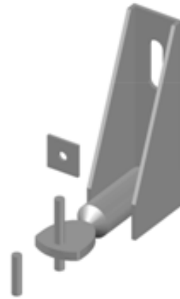
Figura 6.13, Ganci Halfen per ancoraggio pannelli EASEE. Fonte Politecnico di Milano
