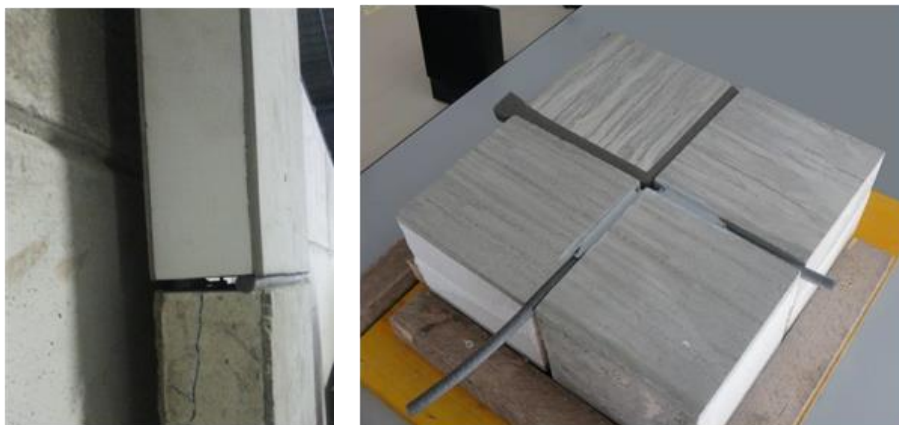
Figura 6.5, Giunto di tenuta all'acqua pannello EASEE. Fonte Politecnico di Milano
