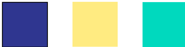
Figura 5.1 Schematizzazione colorazioni campioni funzionali in Ti, grado 2, Sx 25 V, Centro 60 V, Dx 90 V
