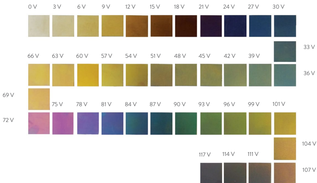
Figura 7.1 Prima scala cromatica titanio, grado 2, \text{NH}_4\text{BF}_{4(7.5\%)} 10\text{mA}/\text{cm}^2
