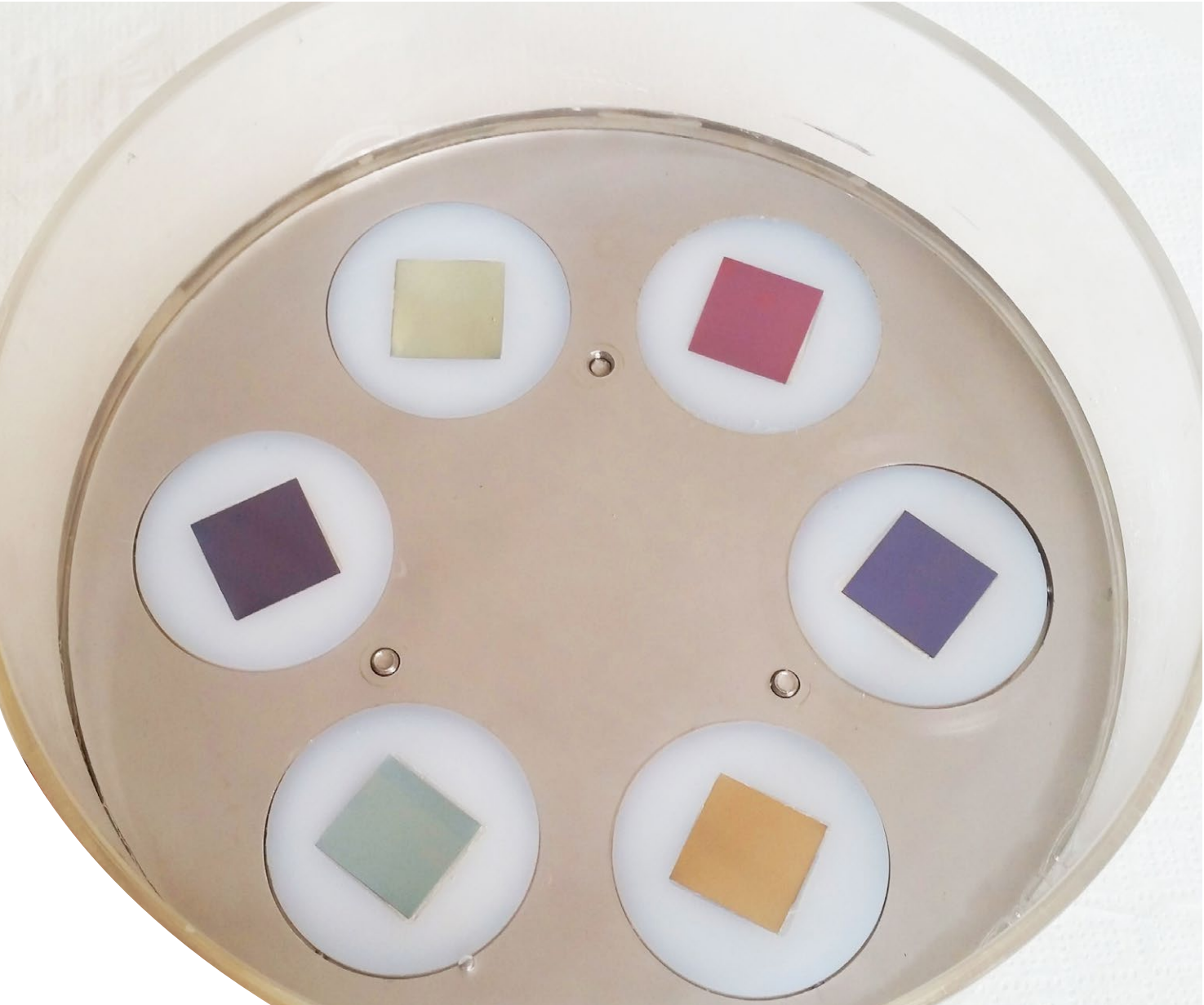
Fig. 5.19 Configurazione porta campioni e sostegno metallico prove Pin On Disk pre-usura campioni Ti
