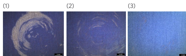
Fig. 4.24 Micrografie allo stereomicroscopio di ossidi di Titanio anodizzati a 30 V in (1, 2) H_2SO_4(0.7M) e (3) H_2SO_4(2M) soggetti ad usura di Tipo 1 con dentifricio (1), Lysoform (2) e sudore sintetico (3)
