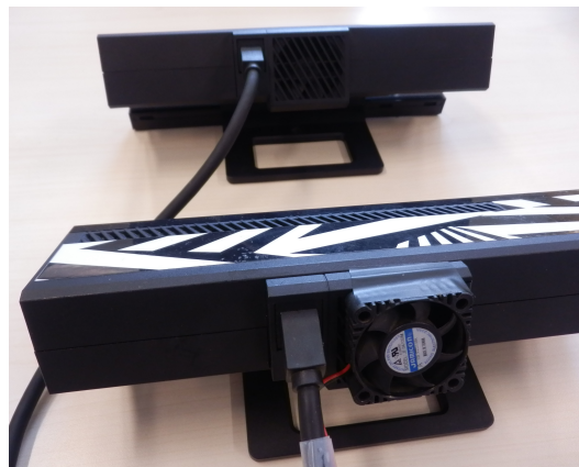
Figura 5.2. Kinect V2 prima e dopo l'installazione del sistema di raffreddamento esterno.
