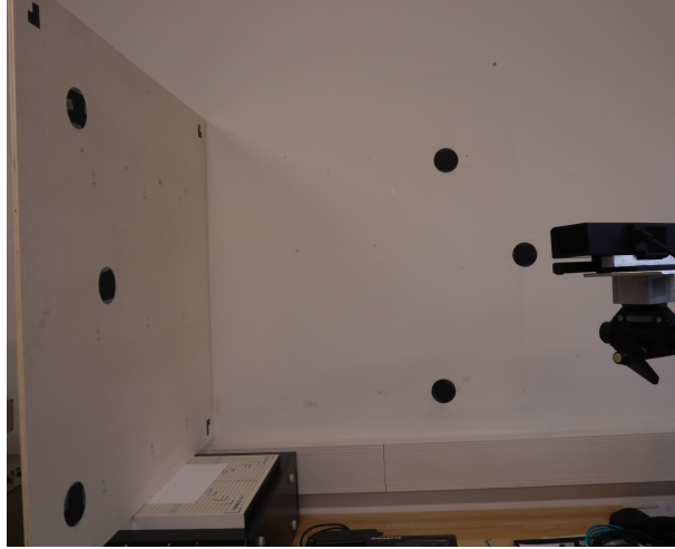
Figura 5.25. Setup utilizzato per l'analisi delle riflessioni multiple; si notino i marker utilizzati per ricavare la rototraslazione dei due sistemi di riferimento.
