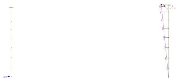
Figura 173 - Modellazione del tratto e diagramma momento y, con azione sismica fuori piano
