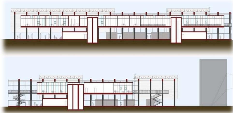
Figura 68 - Sezione longitudinale (in 2 parti) di uno degli edifici del Cardo: Nord B
