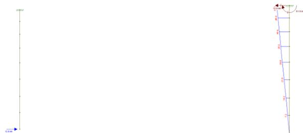
Figura 167 - Modellazione del tratto e diagramma momento y, con azione sismica fuori piano
