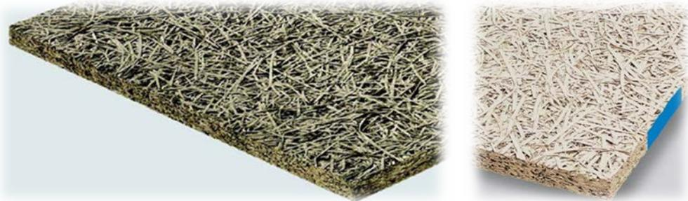
Figura 79 - Pannelli in lana di legno con magnesite
