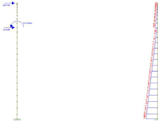
Figura 182 - Modello di carico dell'arco e diagramma momento y, a SLV con sisma fuori piano
