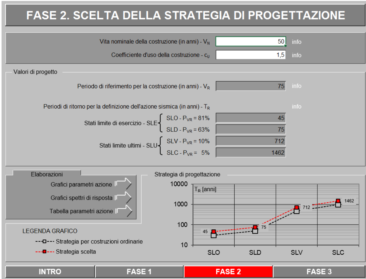
Figura 4.3 – Scelta della strategia di progettazione, mediante foglio di calcolo.
