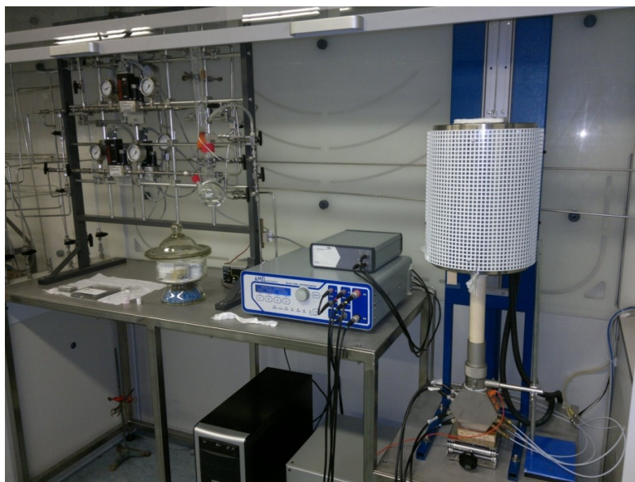
Figura 3.8 – Impianto prove di conducibilità e spettroscopia elettrochimica d'impedenza
