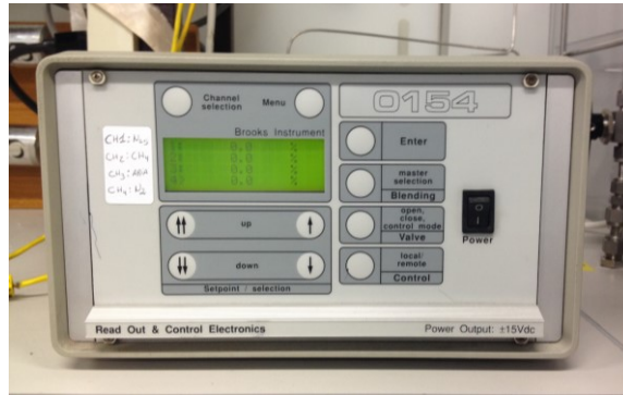
Figura III-8: Immagine della centralina di controllo dei regolatori di flusso
