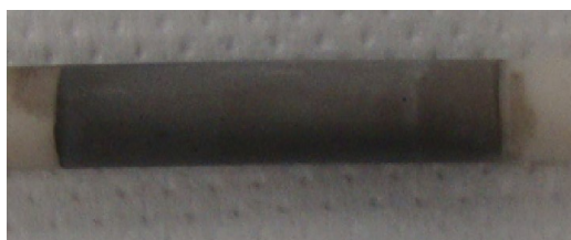
Figura IX-7: Catalizzatore condizionato a 450°C Prima TPO (sinistra) e dopo TPO (destra)
