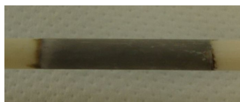
Figura IX-6: Catalizzatore condizionato a 300°C Prima TPO (sinistra) e dopo TPO (destra)
