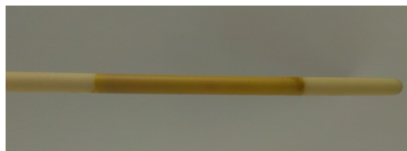
Figura III-14: Tubino con strato catalitico da 4 cm – supporto MgO/Al_2O_3
