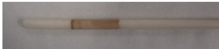
Figura III-13: Tubino con strato catalitico – supporto Al_2O_3
