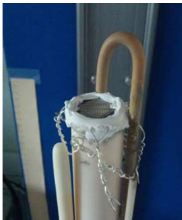
Figura 2.23: Cella montata sul Probostat™ A6 e inserita nell'impianto
