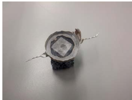
Figura 2.19: Crepe e foro centrale
