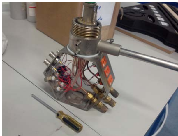
Figura 2.10: Parte interna di un Probostat™ A6
