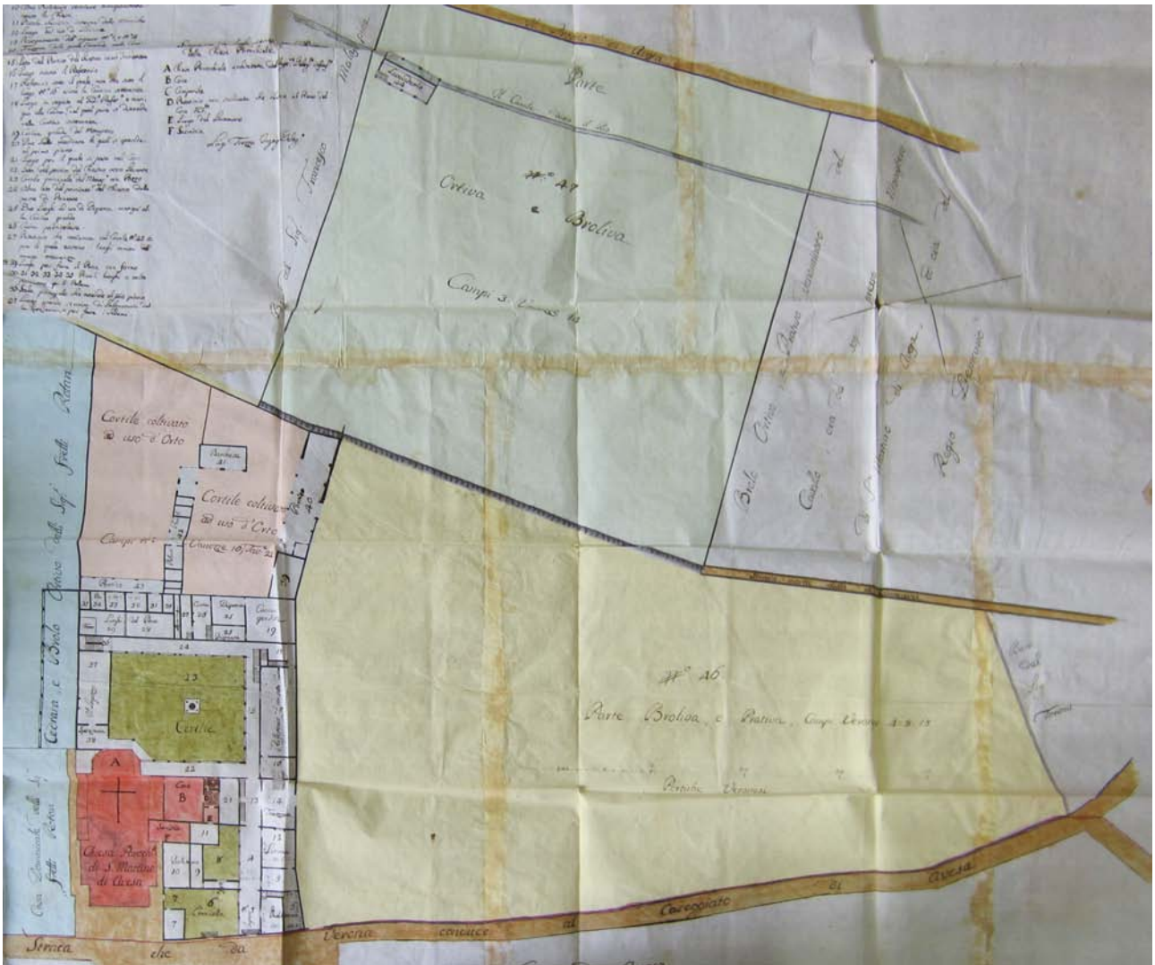
Fig.9 - Disegno dell'antico monastero delle agostiniane di S. Martino d'Avesa, prima della quasi totale demolizione, redatto nel 1807 dall'Ing. delegato Luigi Trezza. Si nota in rosso il corpo della nuova chiesa progettata dallo stesso Trezza, in verde i chiostri del monastero, in giallo a destra il terreno in parte broliivo e prativo (segnato col n.46), in alto in verde chiaro il terreno ortivo e broliivo (n.47) e in rosa i due cortili coltivati ad uso di orto (n.45). In marrone viene indicata la strada comunale in basso e il prognò di Avesa in alto, mentre, a metà disegno notiamo un primo tratto della Carmesana a destra e la continuazione della stessa nella proprietà del monastero per mezzo di un canale sotterraneo. Importante ai fini di questo studio è la proprietà dei conti fratelli Rotàri indicata in azzurro all'estrema sinistra del disegno. In questa piccola porzione di pianta è possibile vedere la conformazione che aveva la "cedrara", fabbricato dove i Rotàri coltivavano principalmente le piante di limone. Il brolio dei fratelli Rotàri confinava dunque con l'antico monastero a Nord, la strada comunale a Est e col brolio del Sig. Francesco Malaspina a Ovest. 51
