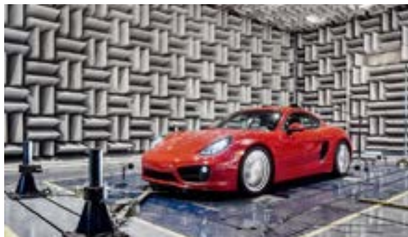
Analisi di un motore Porsche in una camera anecoica.
