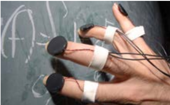
Microfoni a contatto captano il raschiare delle unghie sulla lavagna
