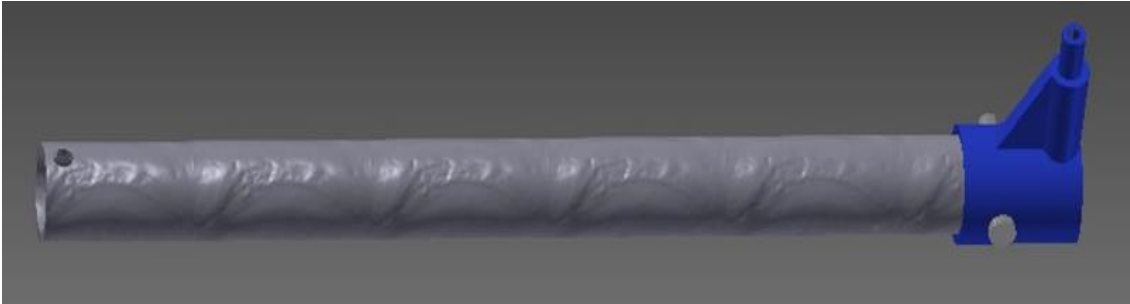
Fig. 79: Shank link . Rappresentato in blu è visibile il supporto al quale lo smorzatore è incernierato nella sua parte inferiore. Una nervatura ha lo scopo di irrigidire la parte cilindrica che funge da cerniera. Un perno ha la funzione di bloccare il supporto dello smorzatore sul tubo.
