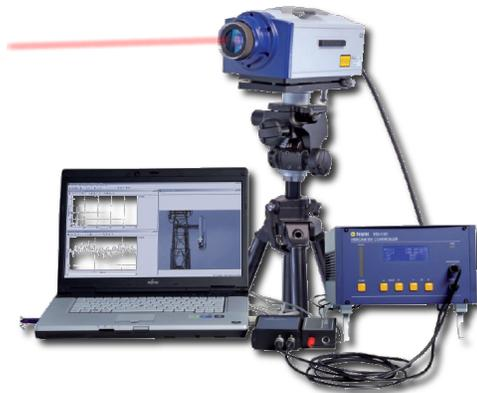
Figura 3.1: Vibrometro laser.
