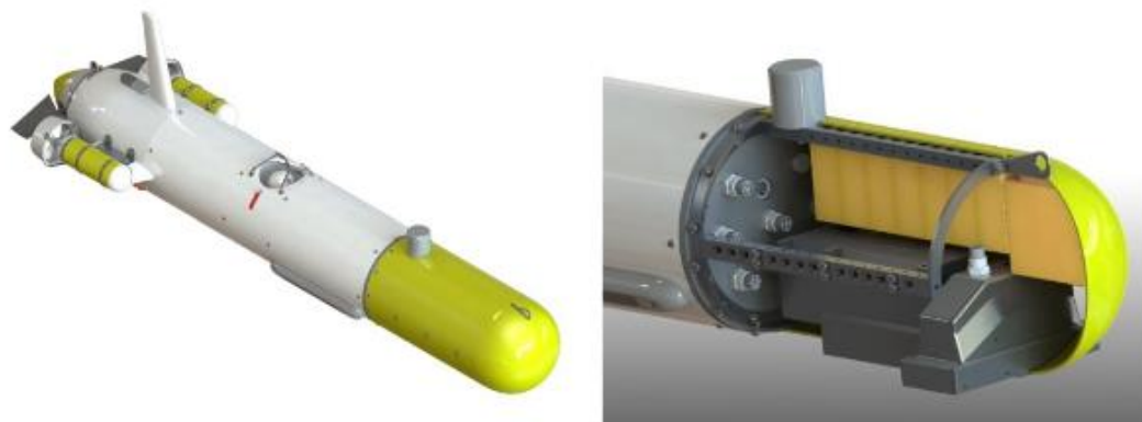
Figura 2.3.1. Disegno CAD del robot SPARUS II (a sinistra). A destra è rappresentata la sezione frontale che può essere configurata dalle squadre.
