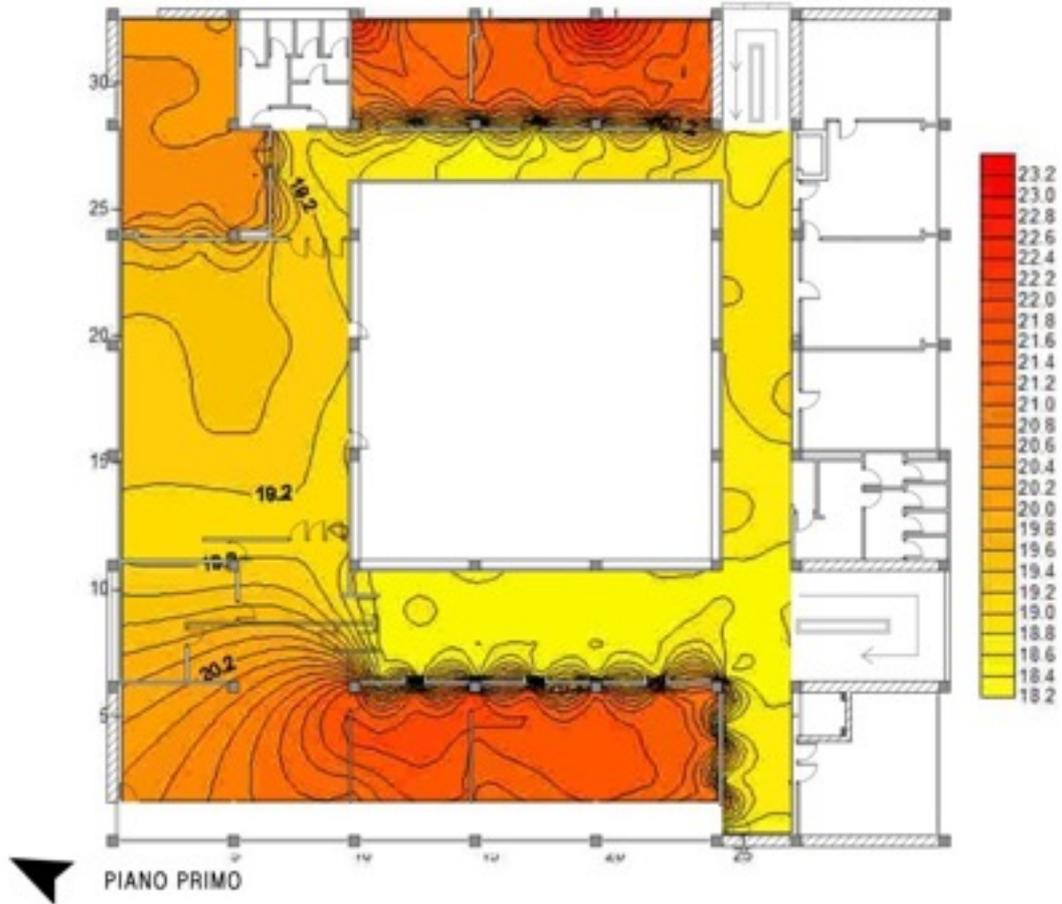
fig.8.8. Rilevazione Temperature ore 15.00 - Piano Primo – Lo spegnimento dell'impianto di riscaldamento e il termine delle attività all'interno degli uffici favoriscono la diminuzione delle temperature all'interno delle stanze. In questo caso però, a differenza del piano terra il calore dissipato dalle stanze non si accumula nel corridoio comune perché le ante in vetrocemento a soffitto disperdono velocemente il calore.
