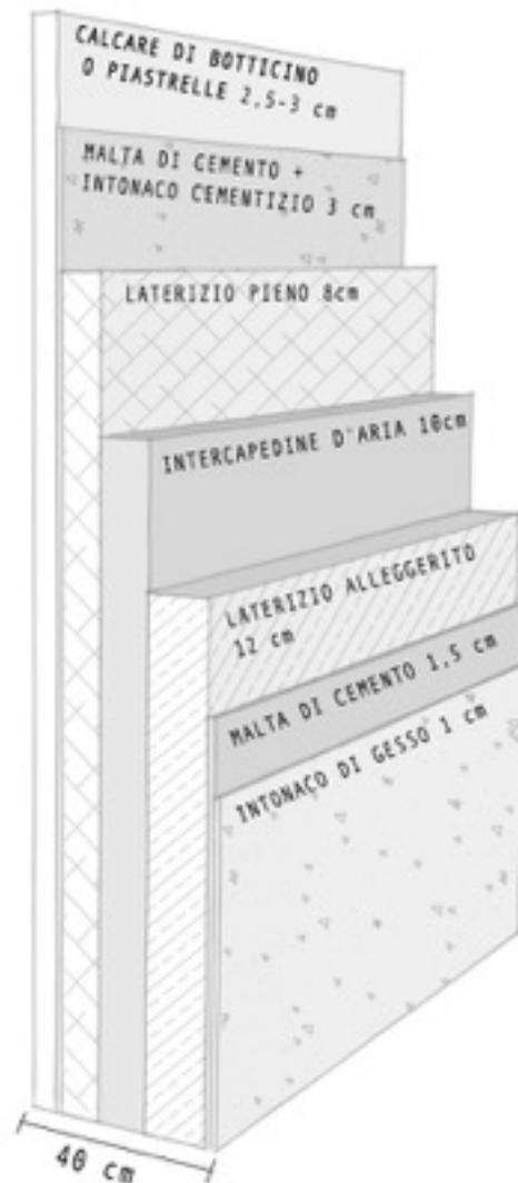
fig. 4.38 Dettaglio della stratigrafia delle pareti perimetrali.
