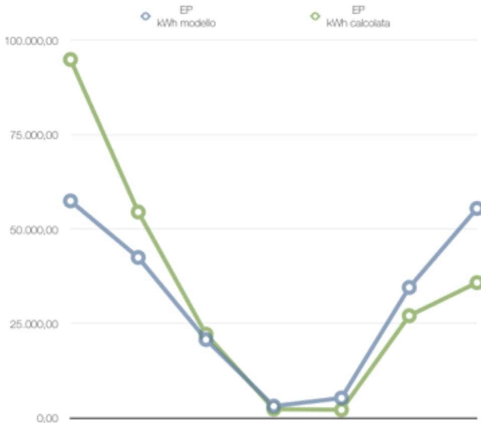
Fig 9.16. Grafico di sovrapposizione dei comportamenti nei mesi presi in considerazione per il calcolo dell'energia primaria ricavati dall'elaborazione dei dati della caldaia e i risultati del modello.
