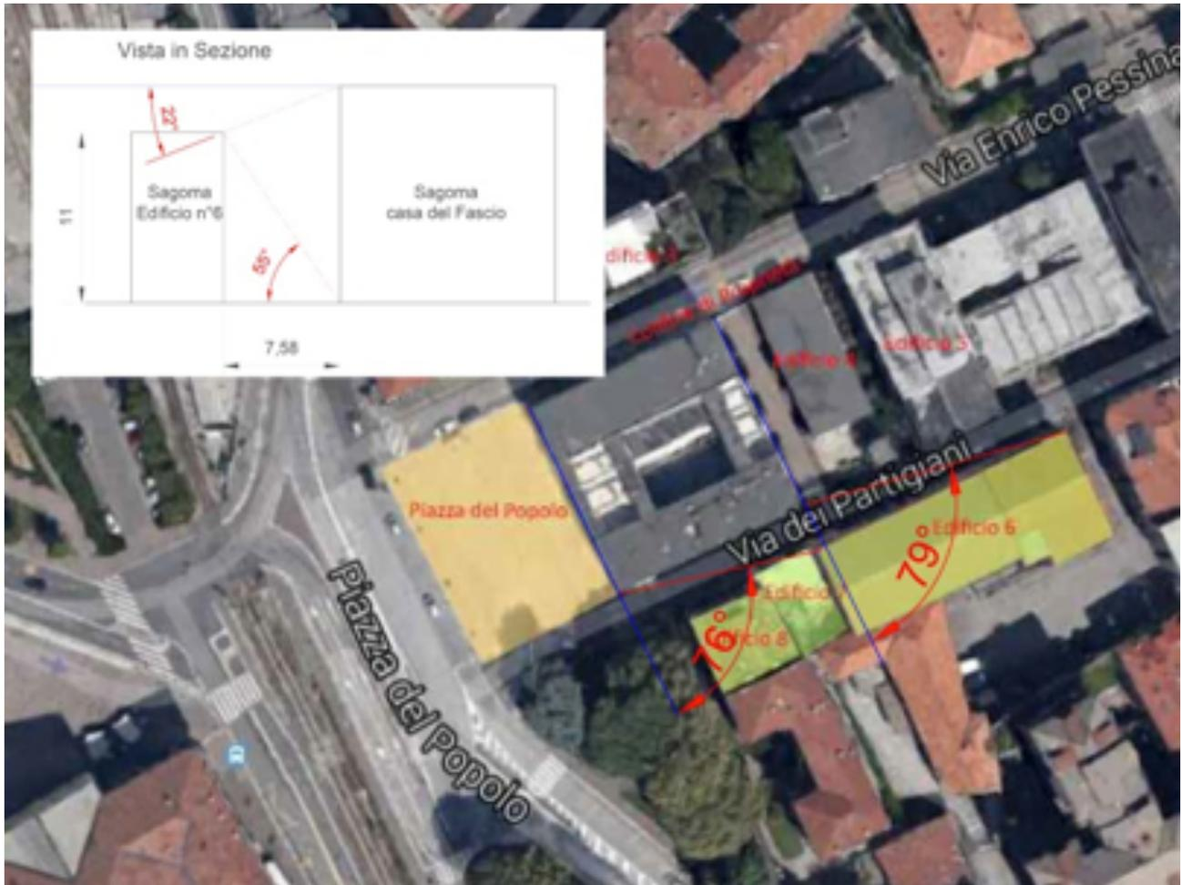
fig. 5.35 Studio grafico del rapporto 'posizionamento-altezza' tra la Casa del Fascio e l'edificio n°6 – In particolare si determinano i gradi di sfalsamento della posizione dell'edificio n°6 rispetto alla Casa del Fascio, i rapporti tra le altezze dei due e la rispettiva distanza tra i corpi di fabbrica.
