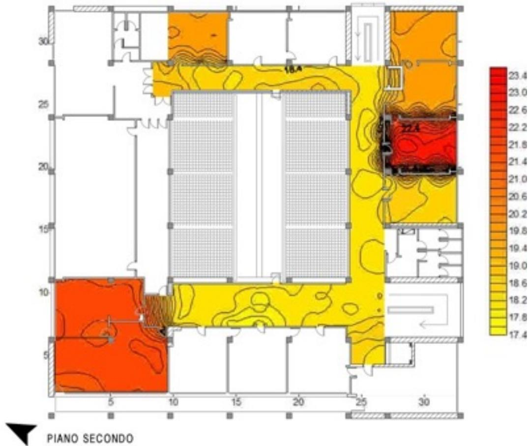
fig.8.10. Rilevazione Temperature ore 9.45 - Piano Secondo – Tale rilevazione denota l'aumento delle temperature delle stanze utilizzate come ufficio (le uniche che si sono potute rilevare in quanto, per le rimanenti non possedevamo l'autorizzazione all'ingresso).
