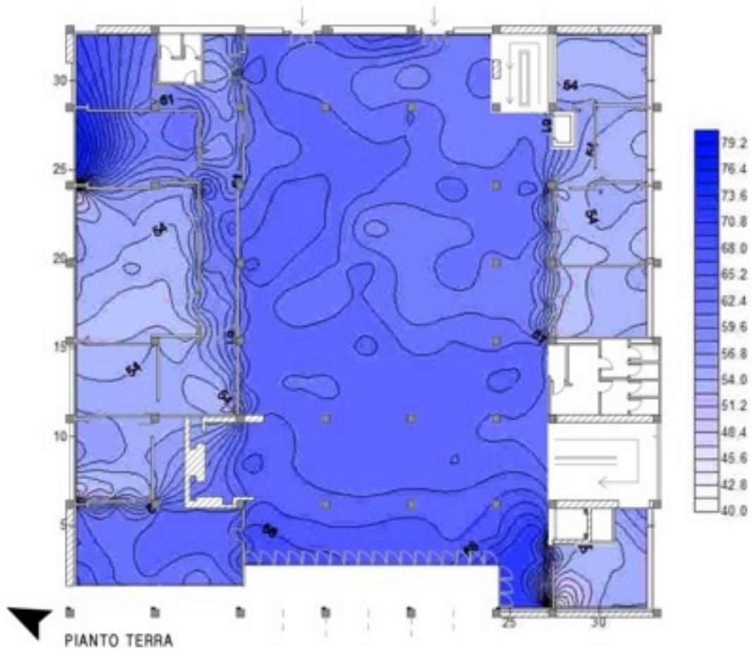
fig.8.3. Rilevazione Umidità ore 9.45 - Piano terra – All'interno dei locali dove nell'immagine precedente si denotava una temperatura maggiore, i valori di umidità risultano più bassi. Tale comportamento è giustificato dalla presenza dell'impianto di riscaldamento in funzione.
