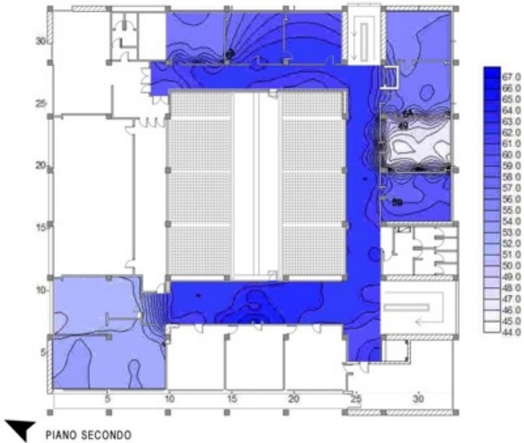
fig.8.11. Rilevazione Umidità ore 9.45 - Piano Secondo – Le umidità rilevate riflettono chiaramente le condizioni d'uso rilevate per le temperature.
