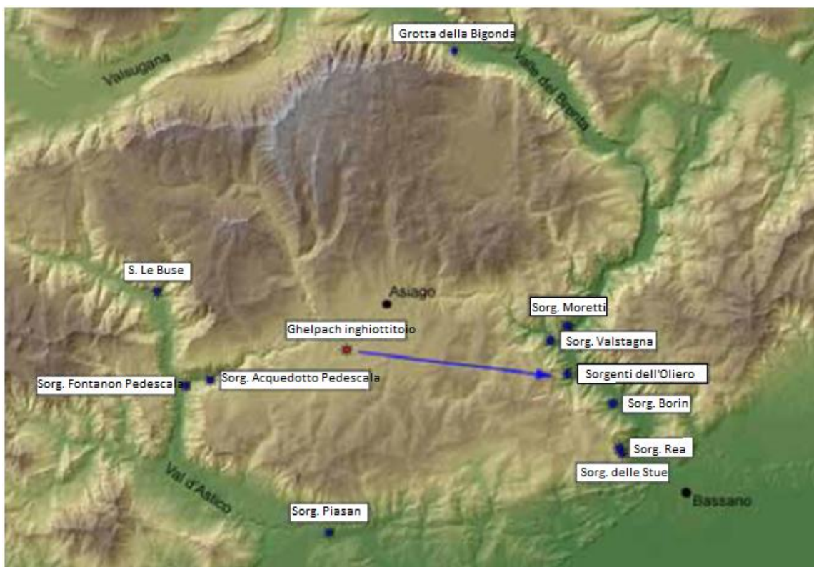
Figura 15: Sorgenti esaminate durante l'esperienza di tracciamento. La freccia indica la connessione del flusso idrico ipogeo dal punto di immissione (inghiottitoio nel T. Ghelpach) alle sorgenti dell'Oliero
