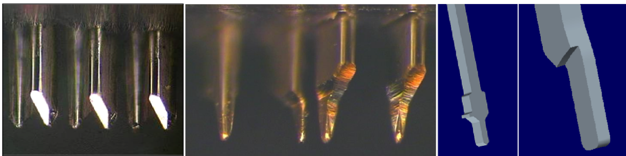
Figura IV-7: diverse geometrie delle punte di aghi per tecnologia verticale
