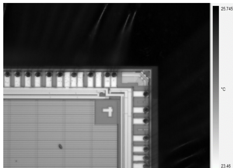
Figura 4.6: Dettaglio di immagine di topografia di dispositivo aperto da frontside
