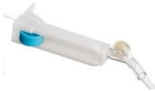
Figura 4.11: stringitubo “ roller clamp ” utilizzato durante le prove sperimentali con Arduino come resistenza variabile.
