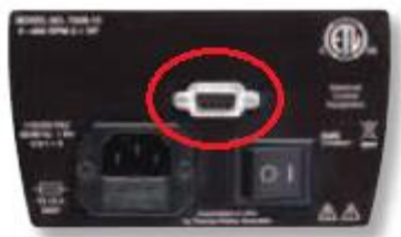
Figura 4.4: particolare della pompa peristaltica a controllo digitale (Masterflex®); in rosso è cerchiato il connettore DB9.
