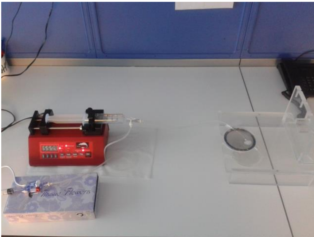
Figura 6.1: set-up sperimentale della prova di perfusione in rampa di portata.
