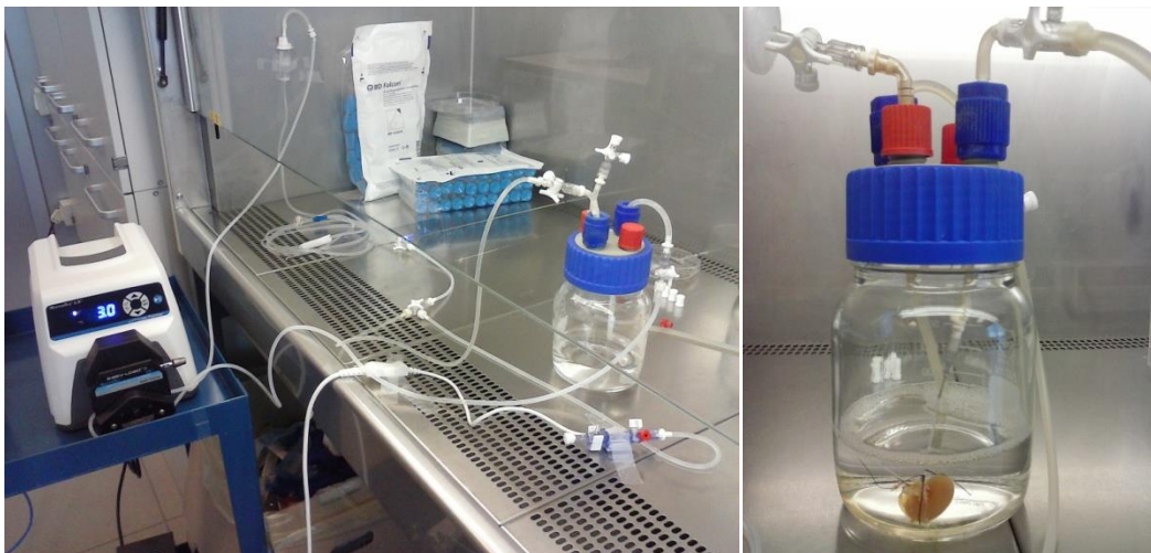
Figura 4.2: A sinistra: fotografia del circuito di perfusione del rene di ratto. A destra: particolare della camera di perfusione.
