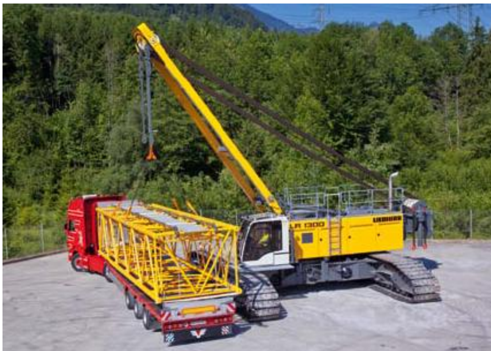
Figura 22 - Fase di montaggio Liebherr LR 1030
