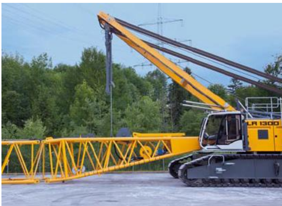
Figura 22 - Fase di montaggio Liebherr LR 1030
